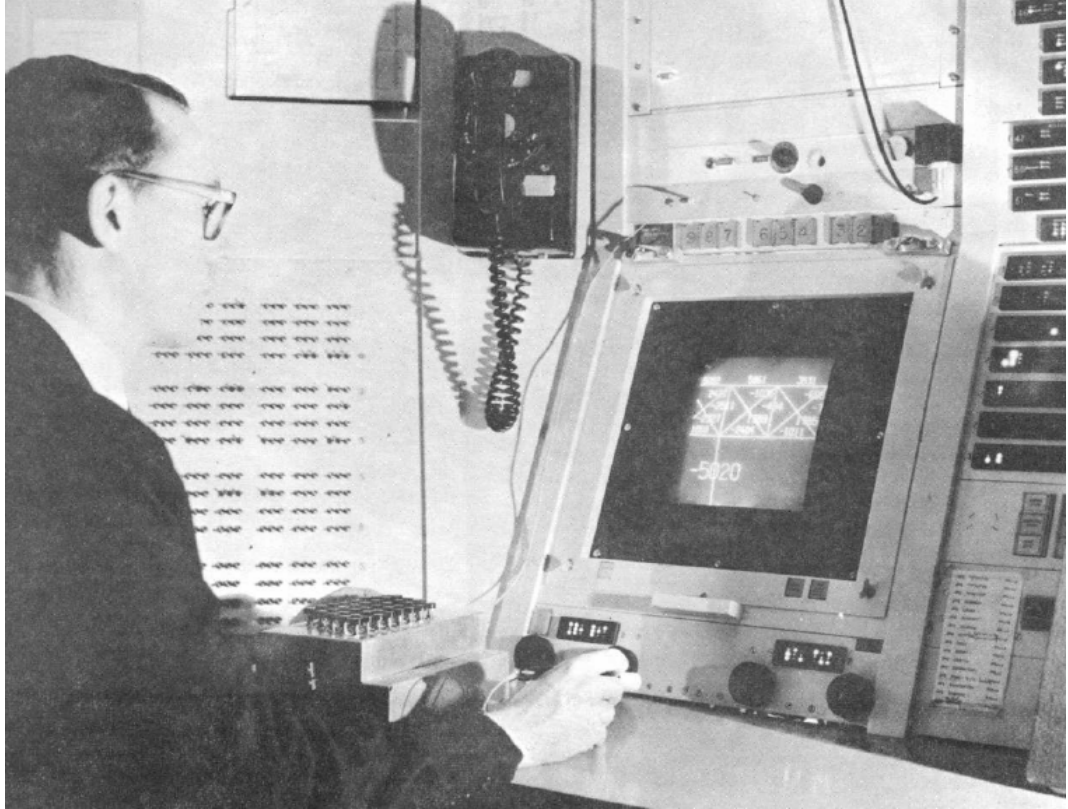
Şekil 2.13 TX-2 Çalışma alanı ve çizim levhasının kullanımı (Sutherland, 2003).
