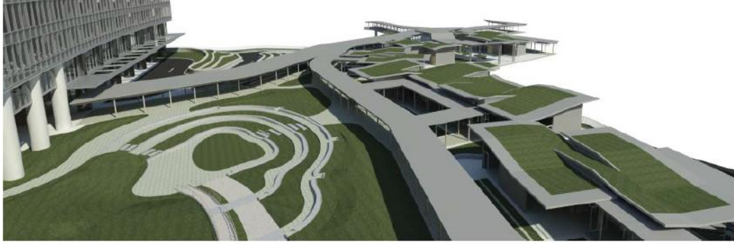
Görsel 4.36. Rampa ve eğimli topografyanın BIM modeli (Sacks, Eastman, Lee, & Teicholz, 2018)
