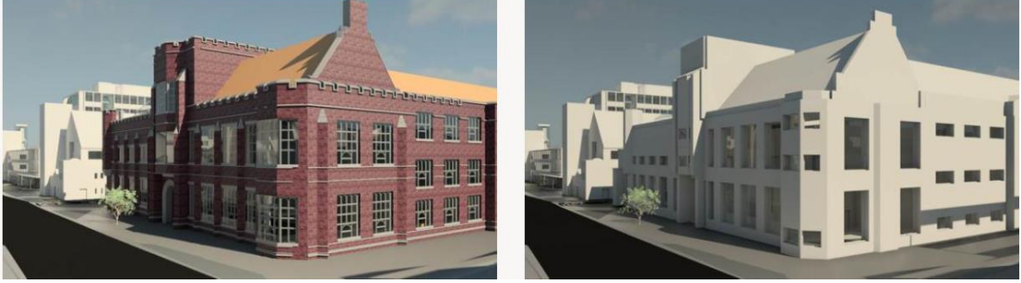
Görsel 4.39. BIM model LOD 500 (soldaki) ve LOD 100 (sağdaki) (Kassem, 2015)
