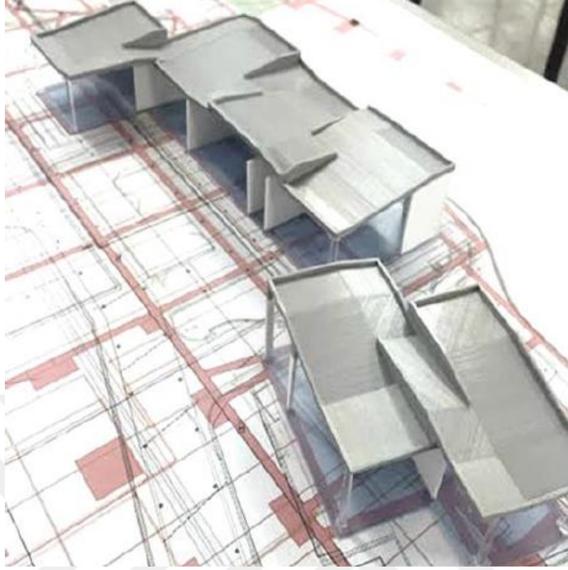
Görsel 4.35. 3B yazıcı ile basılan rampalar (Sacks, Eastman, Lee, & Teicholz, 2018)
