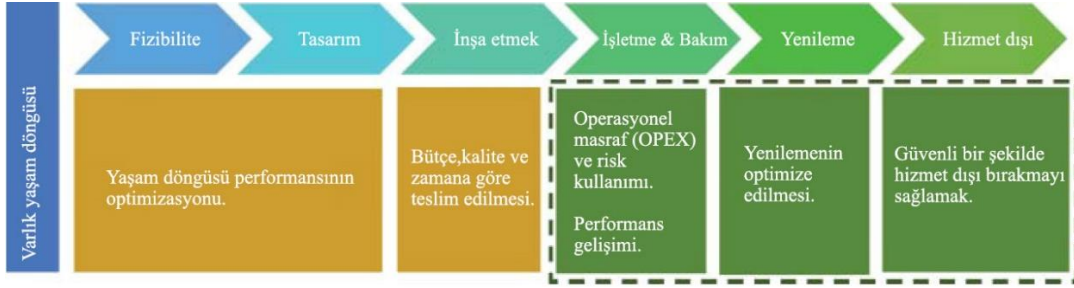
Şekil 3.6. İşletme ve bakım için BIM ve yapı yaşam döngüsü boyunca kullanılan modellerle ilişkisi (Sacks, Eastman, Lee, & Teicholz, 2018)
