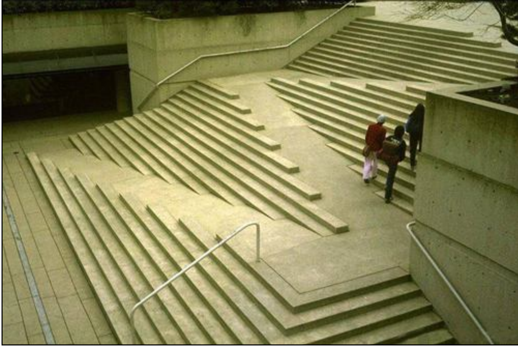
Şekil 4.27. Tekerlekli sandalye rampası ve merdiven tasarımı (URL-36)
