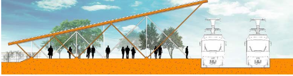
Şekil 29: AWG'nin su toplama aracı olarak entegre edilebileceği çatı yapısını gösteren şematik bir kesit örneği (Bradshaw, 2016)
