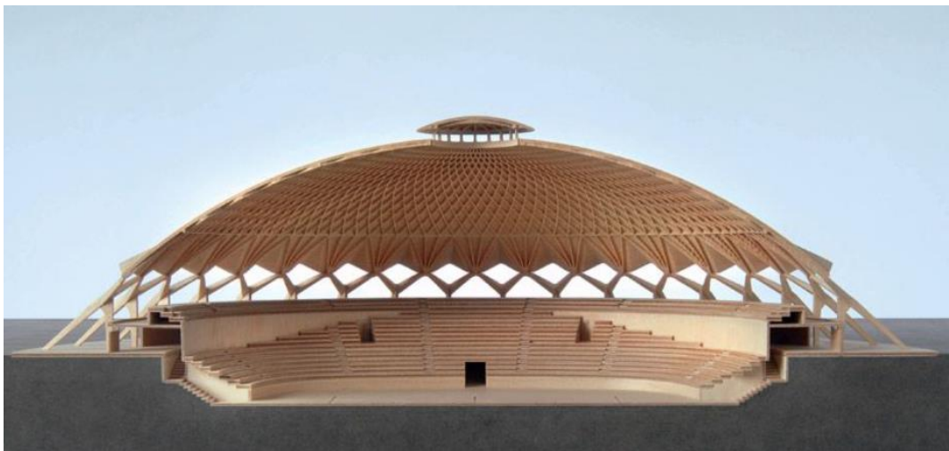
Şekil 4.12. Palazetto dello sport ve uygulanan çatı örtüsü (URL-16)
