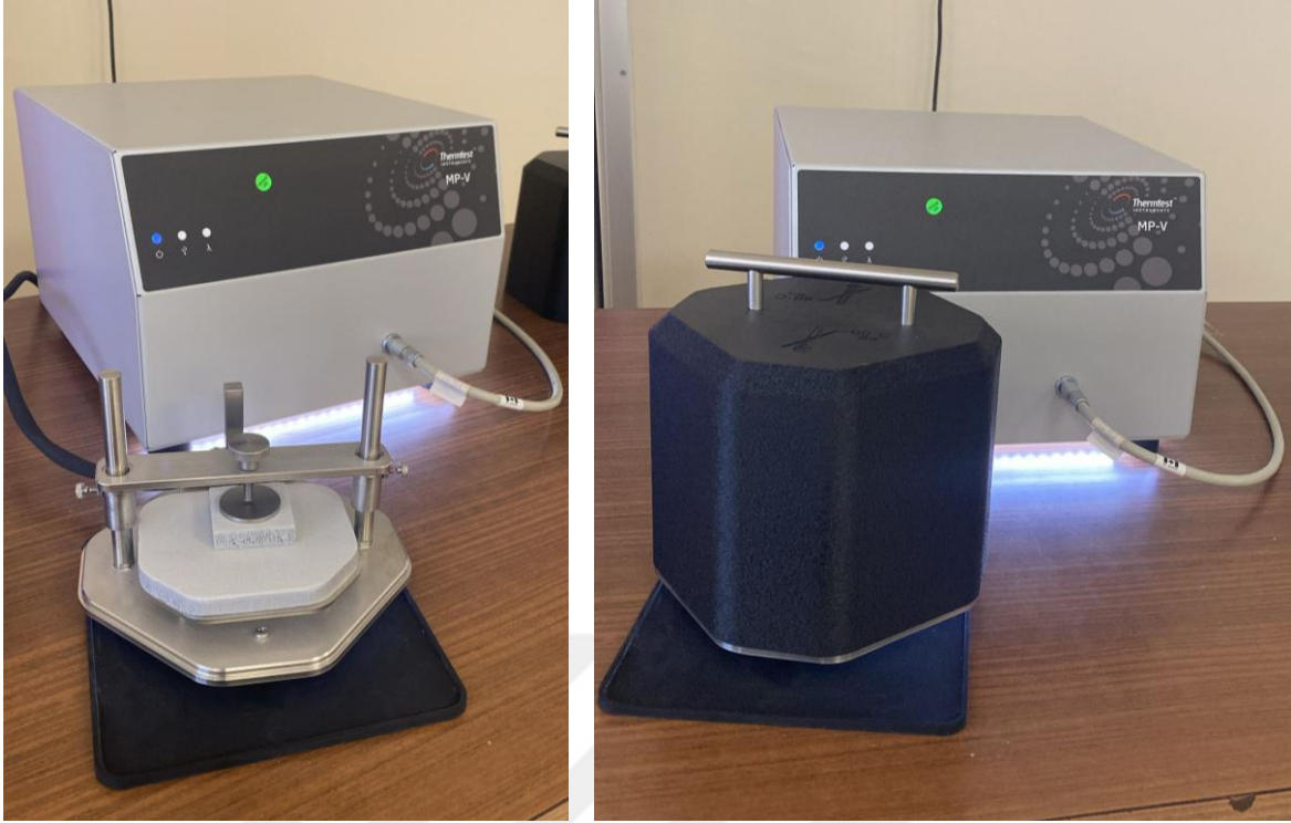
Şekil 34. Isıl iletkenlik testleri test sırasında çekilen bazı görseller: numunenin yerleştirilmesi (solda) ve ölçüm yapılırken (sağda).
