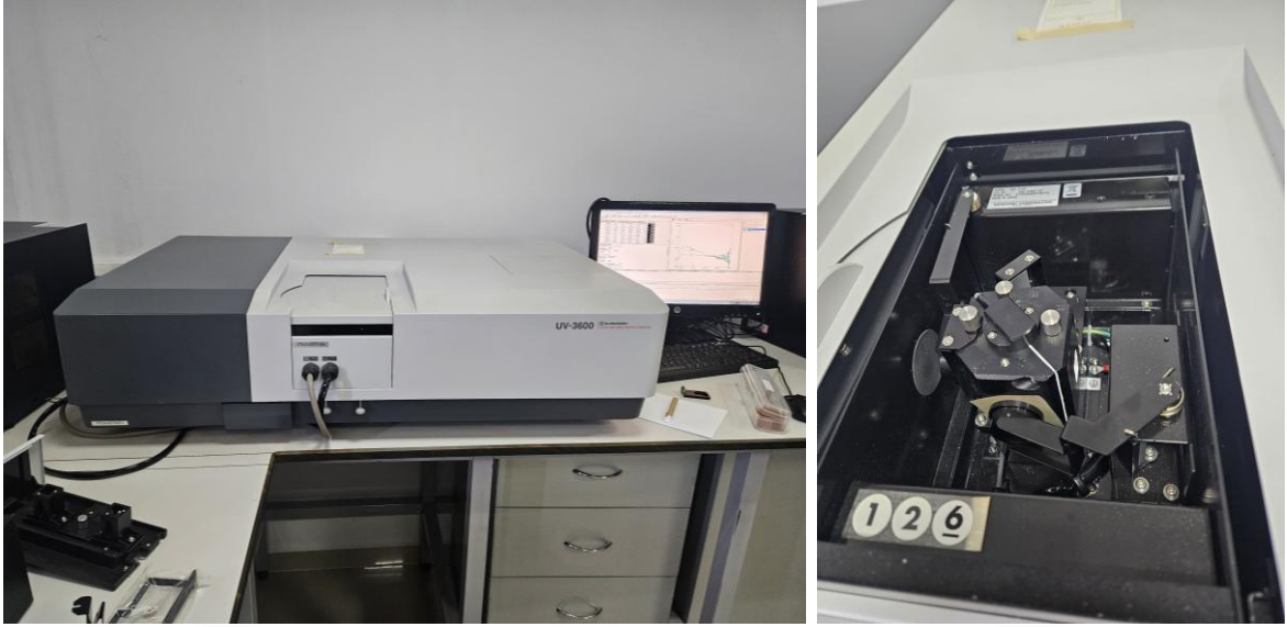
Şekil 33. UV-VIS-NIR Spektrofotometre (solda), numunenin entegre küre eklentisine yerleştirilmesi (sağda)
