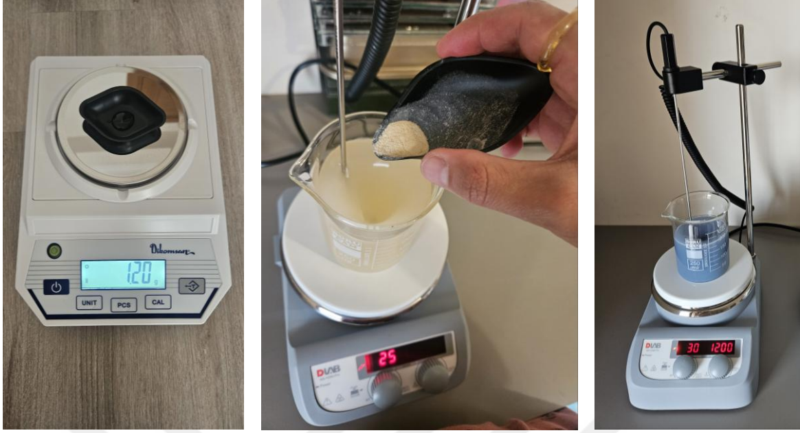
Şekil 26. Numunelerin tartımı (solda), sodyum aljinatın çözeltiye eklenmesi (ortada), ısıtıcıli karıştırıcıda işleme süreci (sağda)
