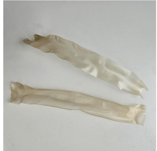
Şekil 28. Kalsiyum klorür çözeltisiyle harici çapraz bağlama işlemi sonrasında numunelerin deformasyonuna dair görseller
