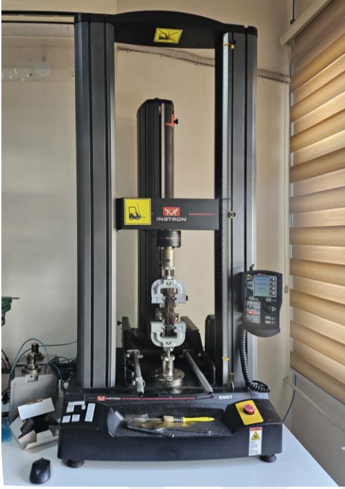
Şekil 31. Çekme test cihazı (solda), dijital mikrometre (sağda)
