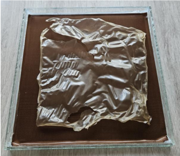
Şekil 28. Kalsiyum klorür çözeltisiyle harici çapraz bağlama işlemi sonrasında numunelerin deformasyonuna dair görseller
