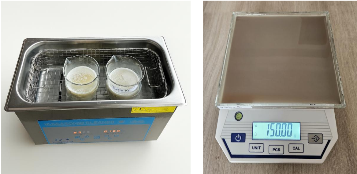
Şekil 27. Numuneler ultrasonik banyoda (solda), teflon kaplamalı cam kalıba çözeltinin henüz dökümü yapılmış hali (sağda)
