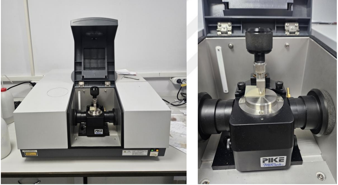
Şekil 30. FTIR spektrometre (solda), numunenin ölçüm alanına yerleştirilmesi (sağda)
