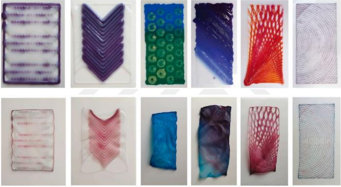
Şekil 6. Doku verici teknikler kullanılarak 3D baskı yöntemiyle üretilen biyoplastik film örnekleri (Zboinska vd., 2023).
