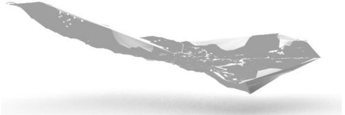
Şekil 57. Gümüşhane Eski Süleymaniye Mahallesi Topografya Çizimi, Rhino Programında “Delaunay Triangulation” kullanılarak yazar tarafından çizilmiştir
