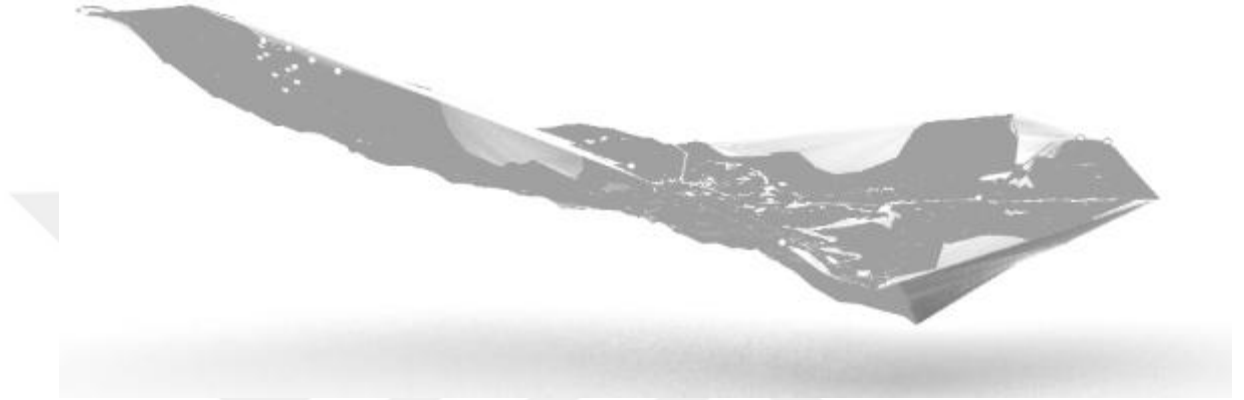
Şekil 53. Gümüşhane Eski Süleymaniye Mahallesi Topografya Çizimi, Rhino Programında “Delaunay Triangulation” kullanılarak yazar tarafından çizilmiştir
