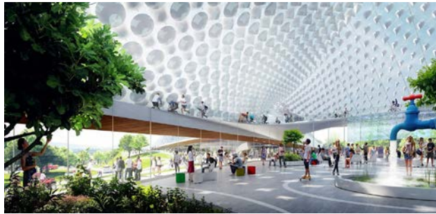
Şekil 3.2: BIG ve Heatherwick tasarımı olan GooglePlex yapısındaki parçalı yapıyı bütünleştirici üst örtünün ışık geçirgenliği (Url-23).
