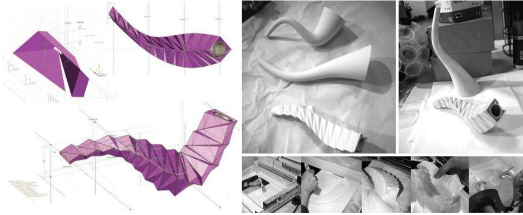
Şekil 4.13. Dijital ortamda hazırlanan objenin 3D yazıcı ile üretimi [38]
