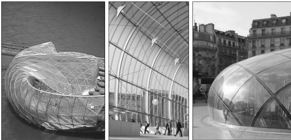
Resim 4.21. Eğrisel yüzey segmentasyonu: soldan sağa: düz paneller (Mur- insel, Graz), tek taraflı eğrisel paneller (TGV Tren İstasyonu, Strasbourg), çift taraflı eğrisel paneller (St. Lazaire metro istasyonu, Paris) [59]
