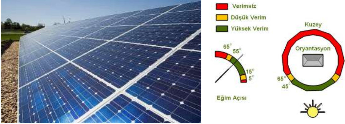
Şekil 3.7. Güneş paneli eğimi ve yönlenmesi (Uzun ve Yeğin, 2017)
