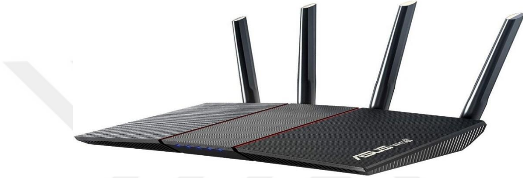
Şekil 3.5. MIMO teknolojisini kullanan modern WIFI yönlendirici
