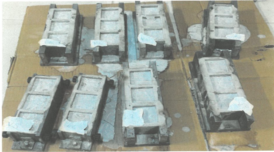
Şekil 3.6. Hazırlanan Numunelerin Kalıp içerisinde Priz Almış Hali
