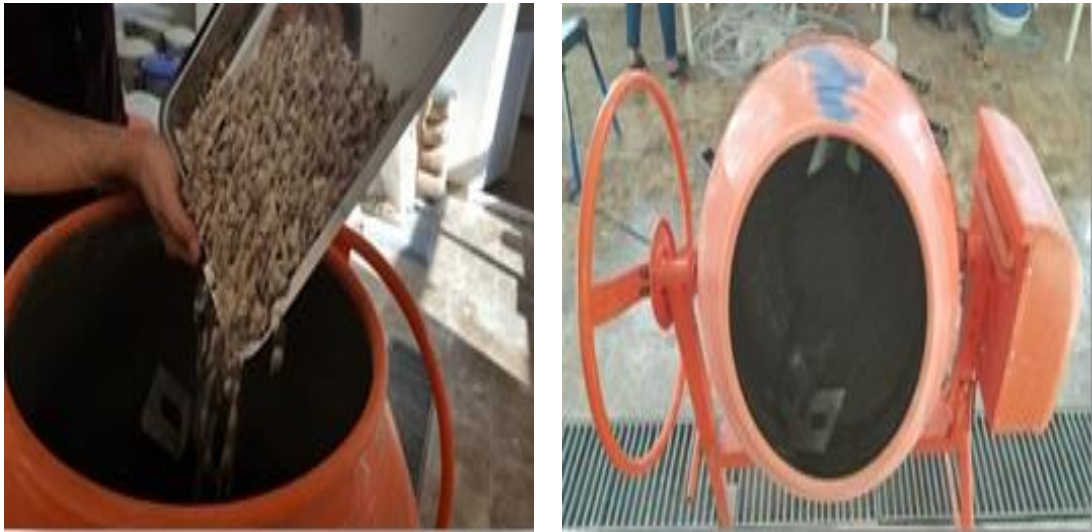
Resim 6.5 Beton Karışımının Hazırlanması
