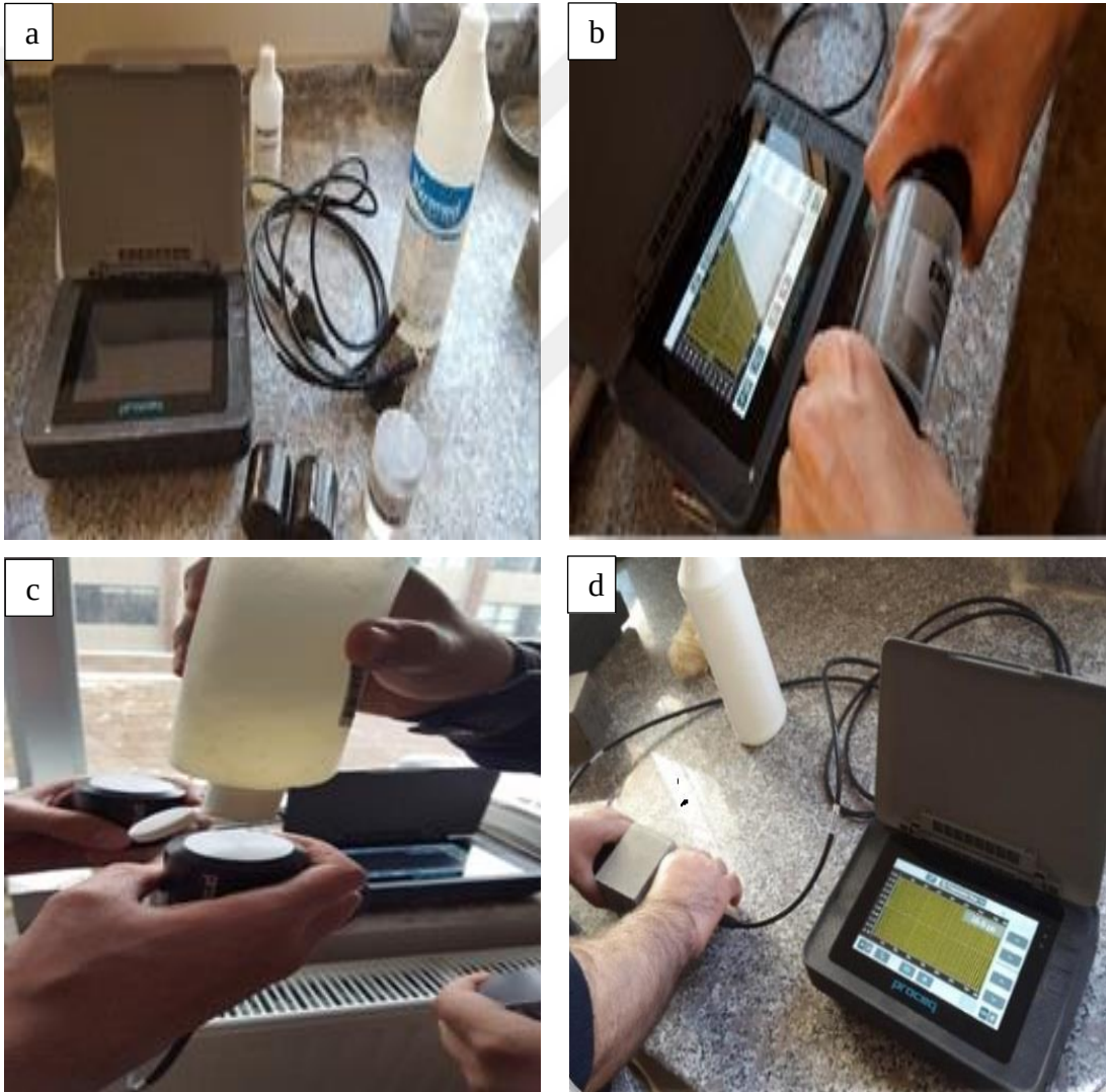
Resim 6.11 Beton Numunelerin Ultrases Ölçümlerinin Yapılması
