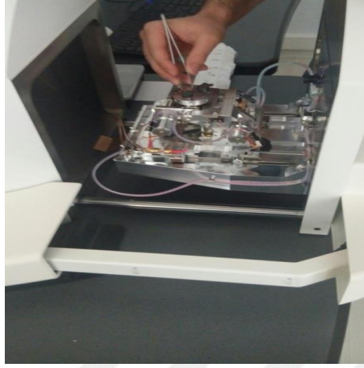
Resim 6.15 Numunelerin SEM Cihazına Yerleştirilme Anı
