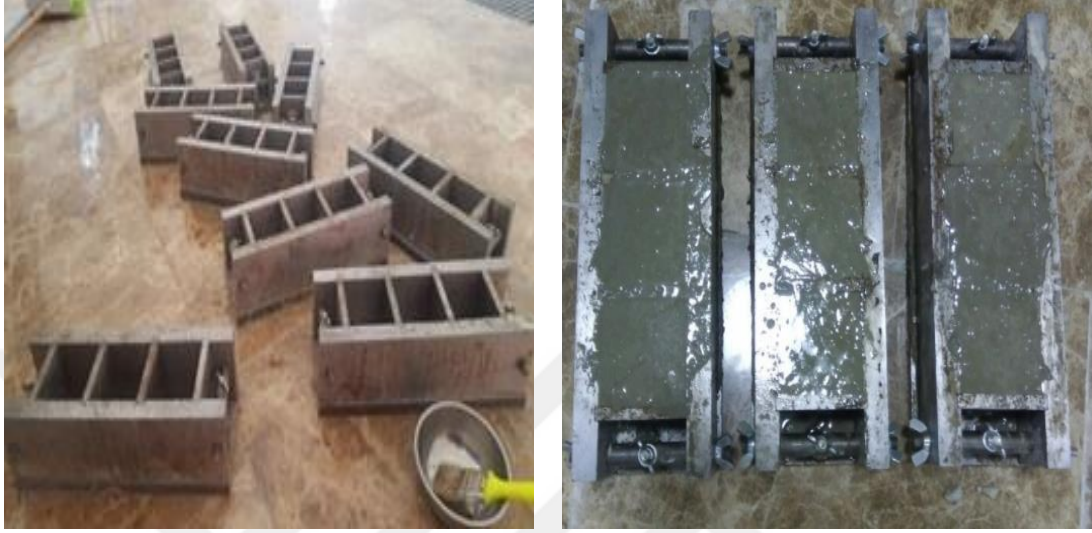
Resim 6.6 Hazırlanan Beton Karışımının Kalıplara Yerleştirilmesi
