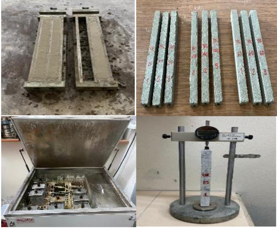
Şekil 20. Kalıplarından çıkarılan harç numuneleri ve ölçüm okumaları kazan içindeki durumlara ait görseller
