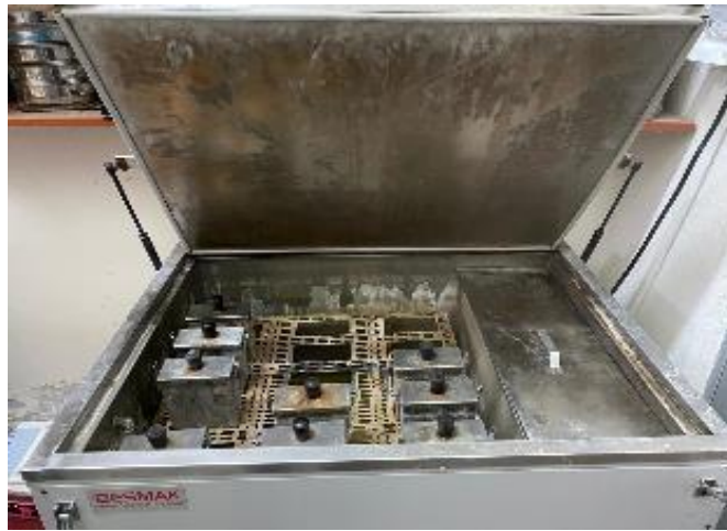
Şekil 12. Deneysel kısımda içerisine harç çubuklarının yerleştirildiği tank
