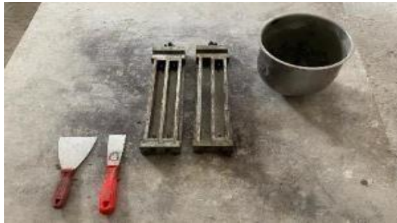
Şekil 19. Prizmatik numune kalıpları ve kalıpları doldurmada kullanılan aparatlar
