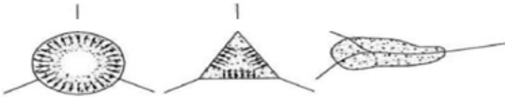
Şekil 2. ASR kaynaklı çatlakların görselleri (Arslan, 2001)
