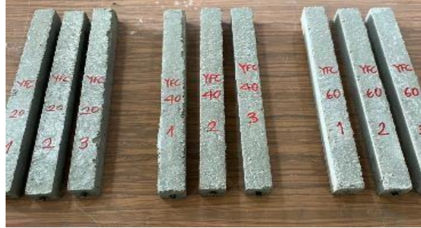
Şekil 10. 25x25x285 mm boyundaki harç çubuklar
