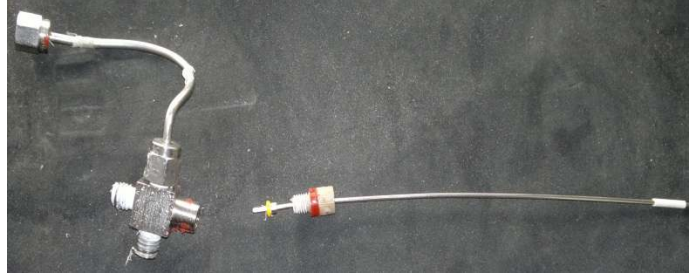
Şekil 3.7 Mikro boru, bağlantı elemanları ve istavroz.
