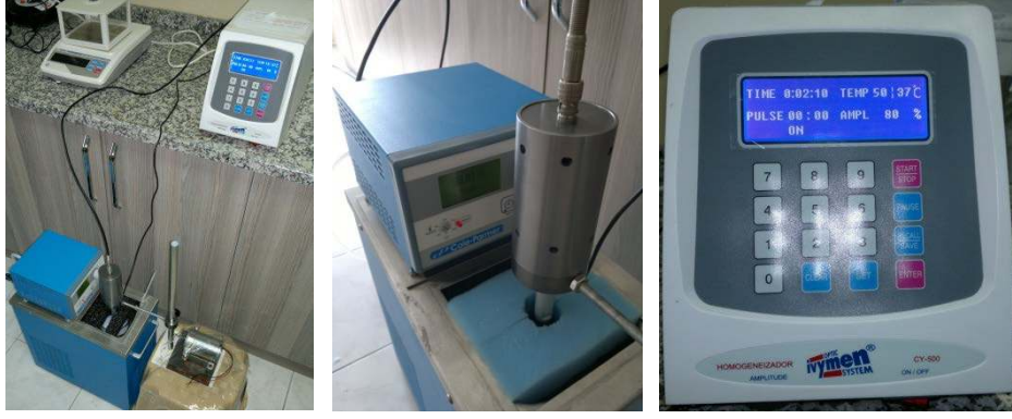
Şekil 3.22 Sıcaklık kontrollü nanoakışkan hazırlama.
