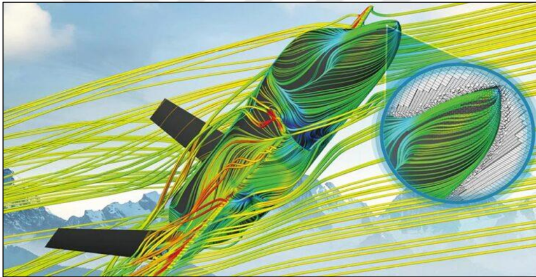
Şekil 2.10 HAD yöntemi ile dış akış çizgileri tasvir edilmiş bir uçak tasarımı. (Econ Engineering, 2019).
