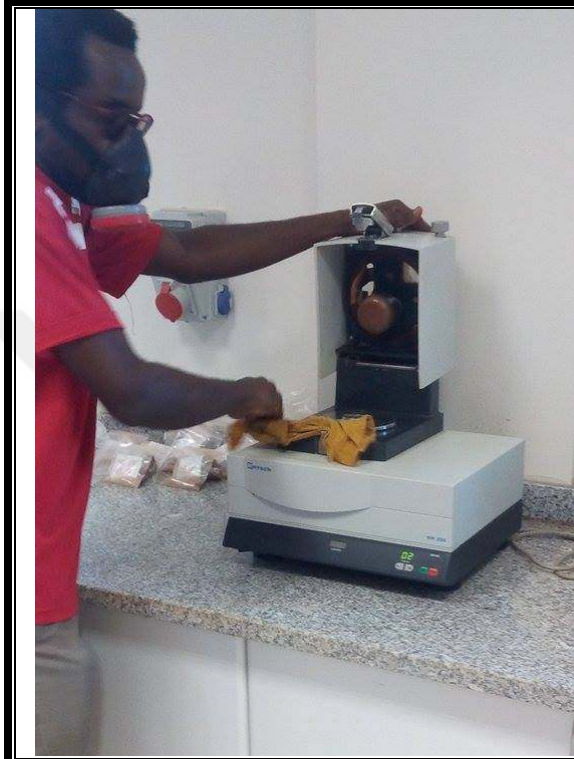
RM 200 Retsch havan öğütücü temizlenmesi.
