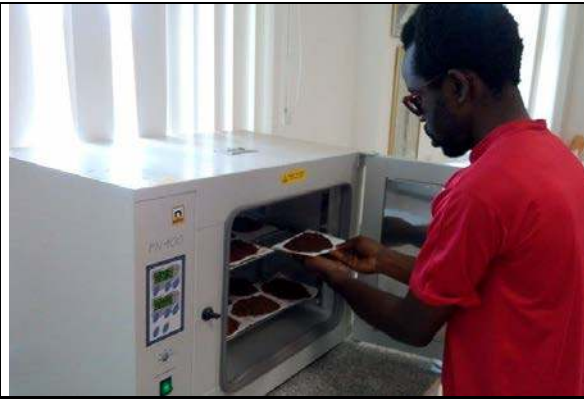
Elektronik fırında Terra-Rosa örneklerinin kurutulması
