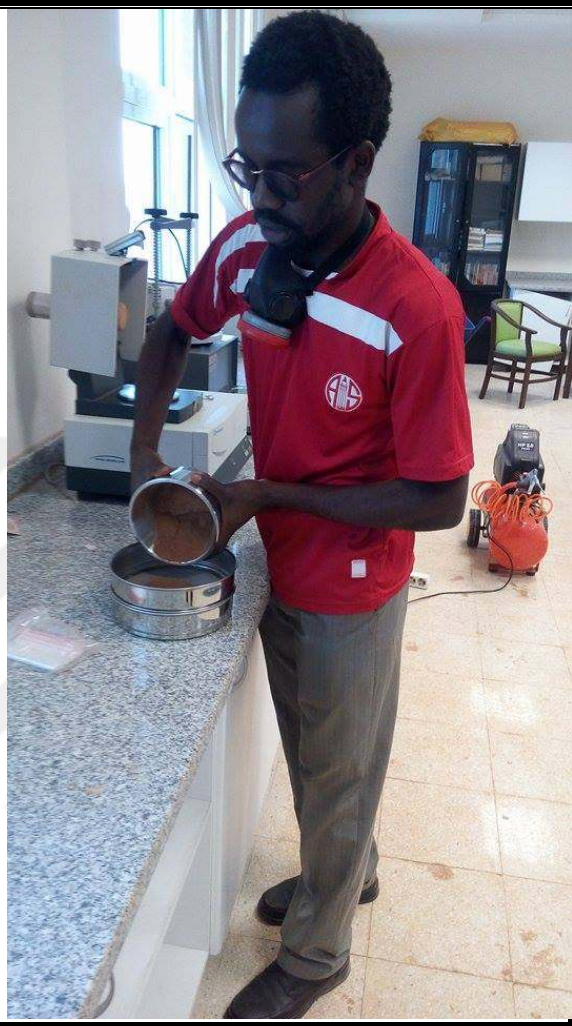
0.063 mikronluk elek içine toprak örnekleri dökme
