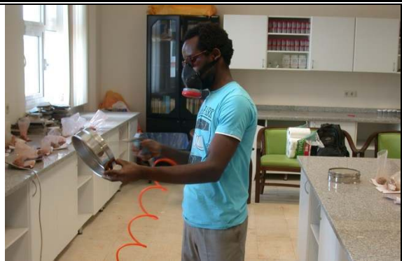
Basınçlı hava ile yılandıktan sonra ekipmanın kurutulması.
