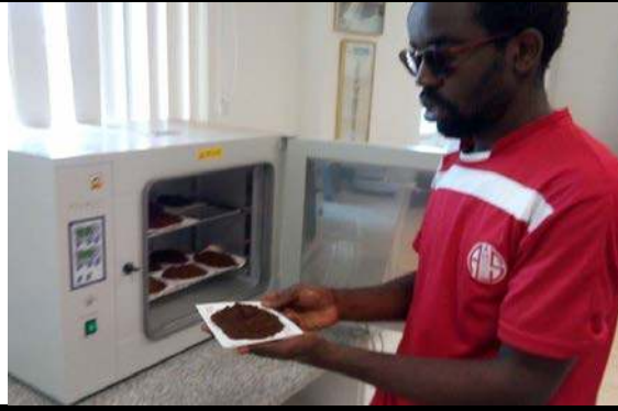
1050 °C'de 24 saat kurutma işleminden sonra fırından kurutulmuş örneklerin çıkarılması
