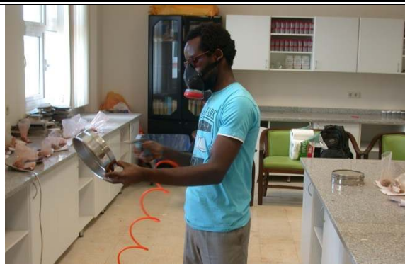
Basınçlı hava ile yılandıktan sonra ekipmanın kurutulması.
