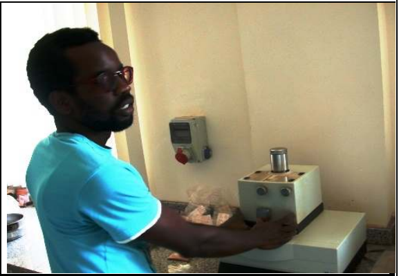
Retsch Havan Öğütücü örneklerin Homojenizasyonu ve öğütülmesi.
