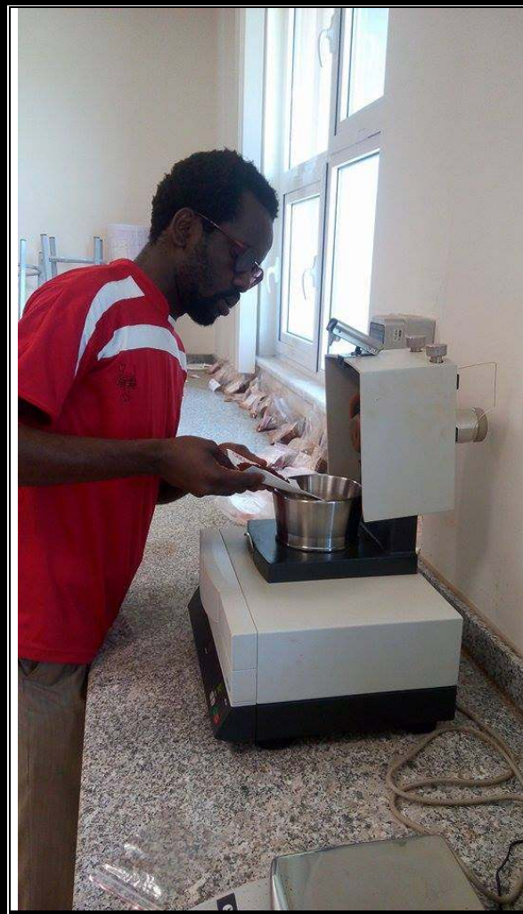
Retsch havan öđütücüye örneđ konulması
