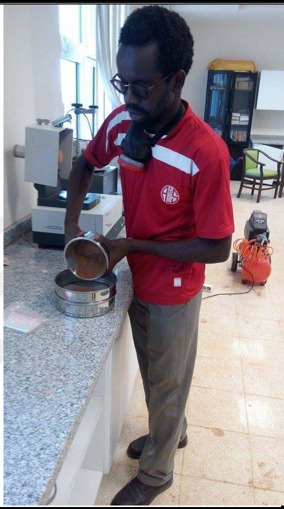
0.063 mikronluk elek içine toprak örneđleri dökme
