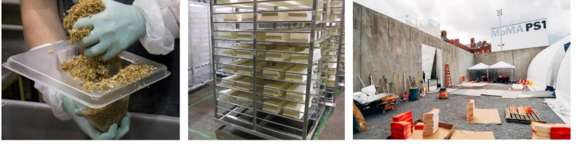
Şekil 39. MBK yapı bloğu üretim akışı; (sol) miselyum ve substrat karışımı, (orta) miselyum kolonizasyonu, (sağ) boyama işlemi (Holcim Foundation for Sustainable Construction, 2015; Nunes, 2014)
