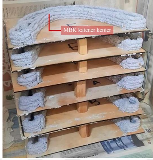
Şekil 112. Tilted Arch MBK katener kemerlerin ikincil kolonizasyonu (Modanloo, vd., 2021)
