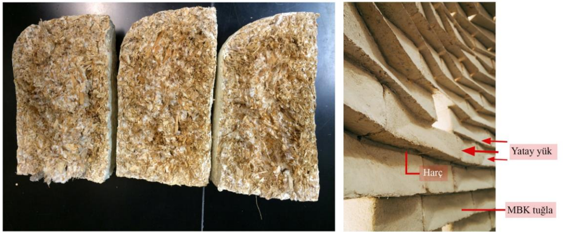
Şekil 40. (sol) MBK yapı bloklarının anizotropik yapısı, (sağ) MBK yığma sistemi
