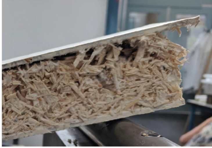
Şekil 22. Ahşap kaplamalı MBSK'de delaminasyon oluşumu (Postel, 2020)
