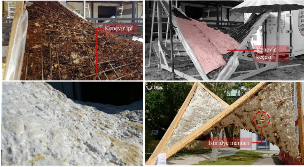
Şekil 30. MBK üretim akışı; (sol üst) kahve telvesi ve miselyum karışımı, (sağ üst) kenevir keçelerinin kenevir ipleri üzerine yerleştirilmesi, (sol alt) miselyum kolonizasyonu, (sağ alt) istiridye mantarı oluşumu (Strunge, 2019)
