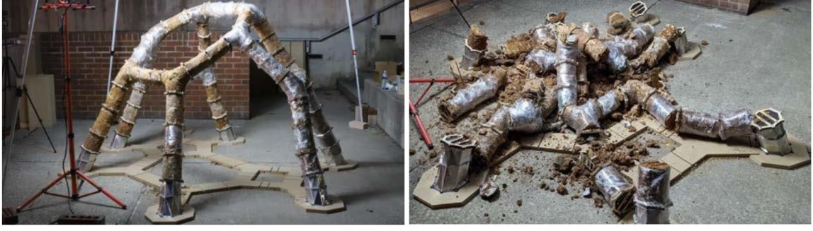
Şekil 20. MycoCreate'in ilk tam ölçekli prototipinin kontaminasyon nedeniyle çökmesi (Ghazvinian, 2023)
