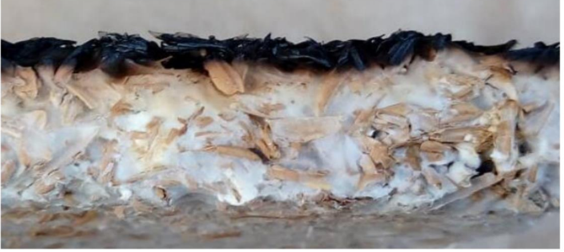
Şekil 21. MBK dış yüzeyinde kömür tabakası oluşumu (Jones, vd., 2017)
