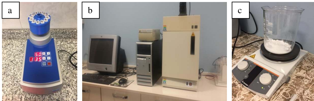
Şekil 3.1 Çalışmada kullanılan cihazlar a) Homojenizatör, b) UV cihazı ve Bilgisayar, c) Isıticılı manyetik karıştırıcı
