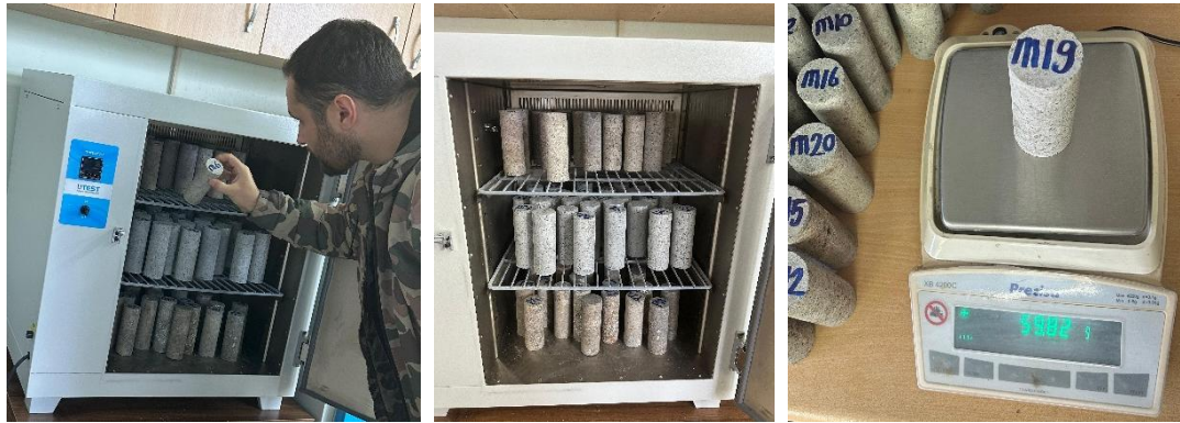
Şekil 6. Etüvde 24 saat boyunca 105 °C'de örneklerin ısıtılması ve kütle ölçümü
