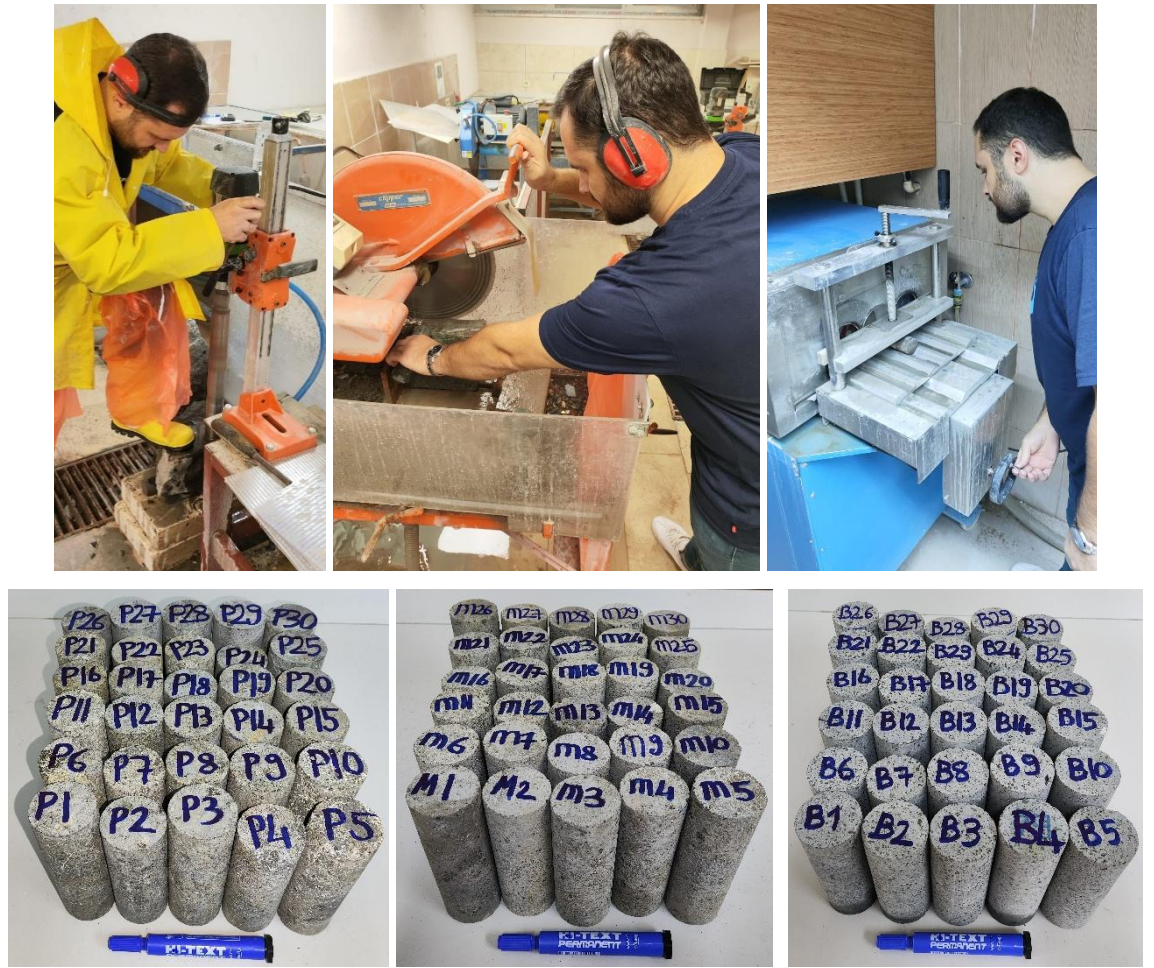
Şekil 3. Tek eksenli sıkışma dayanımı deneyi için örneklerin hazırlanması
