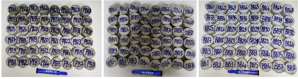
Şekil 4. Dolaylı çekme dayanımı deneyi için örneklerin hazırlanması
