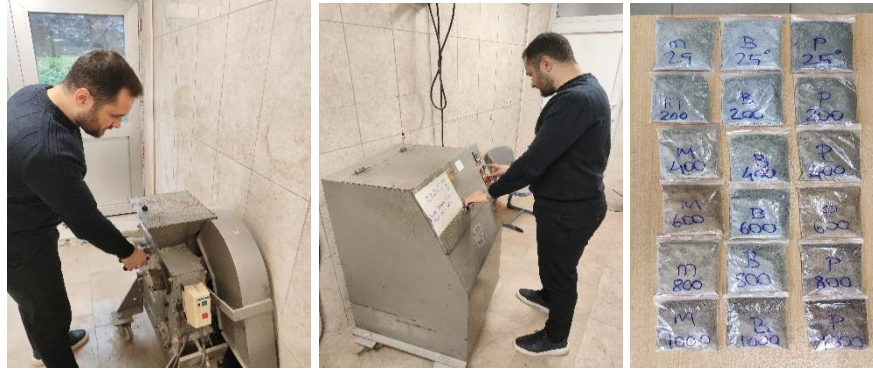
Şekil 7. Piknometre deneyi için örneklerin hazırlanması
