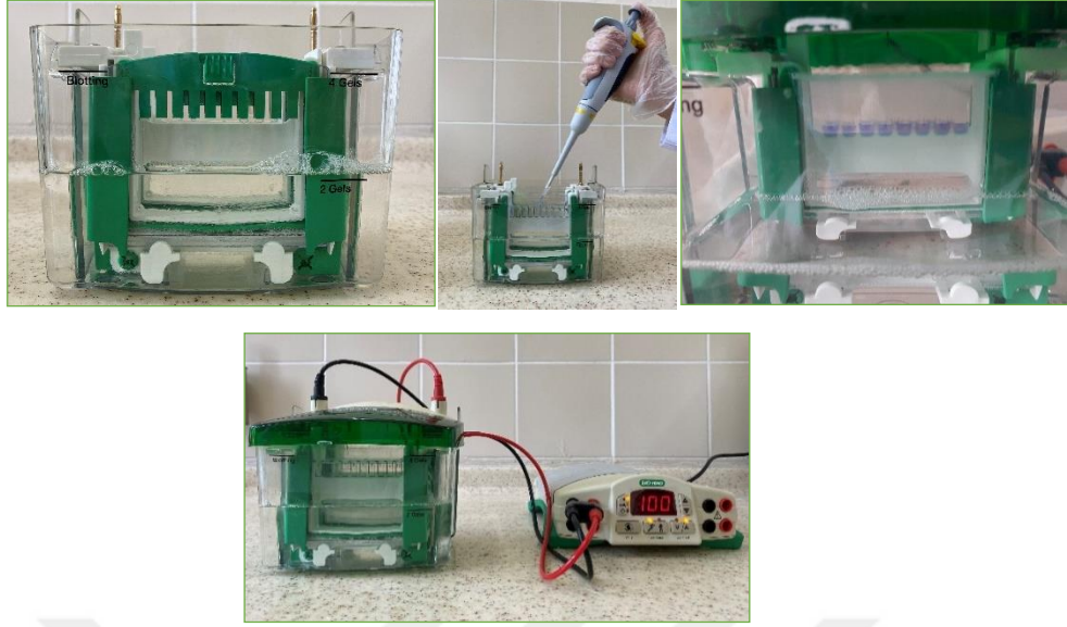
Şekil 19. Proteinlerin jel üzerinde yürütülmesi basamakları.
