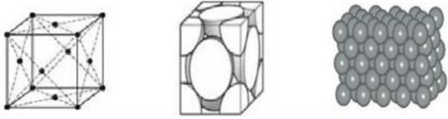
Şekil 3.3. Yüzey merkezli kübik yapı [3]
