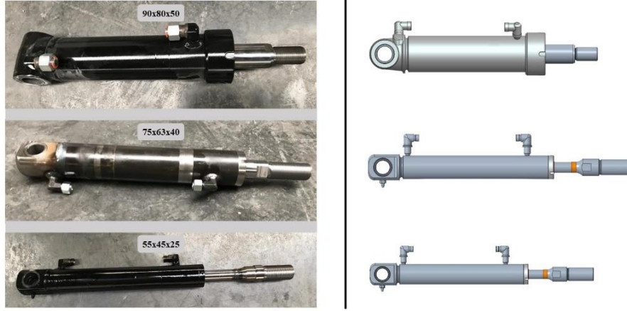
Şekil 3.24. Üretimi gerçekleştirilen üç farklı silindir ve CAD modeli
