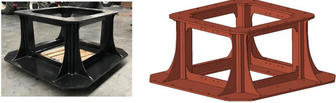
Şekil 3.9. Blok-1 üretim ve tasarım hali
