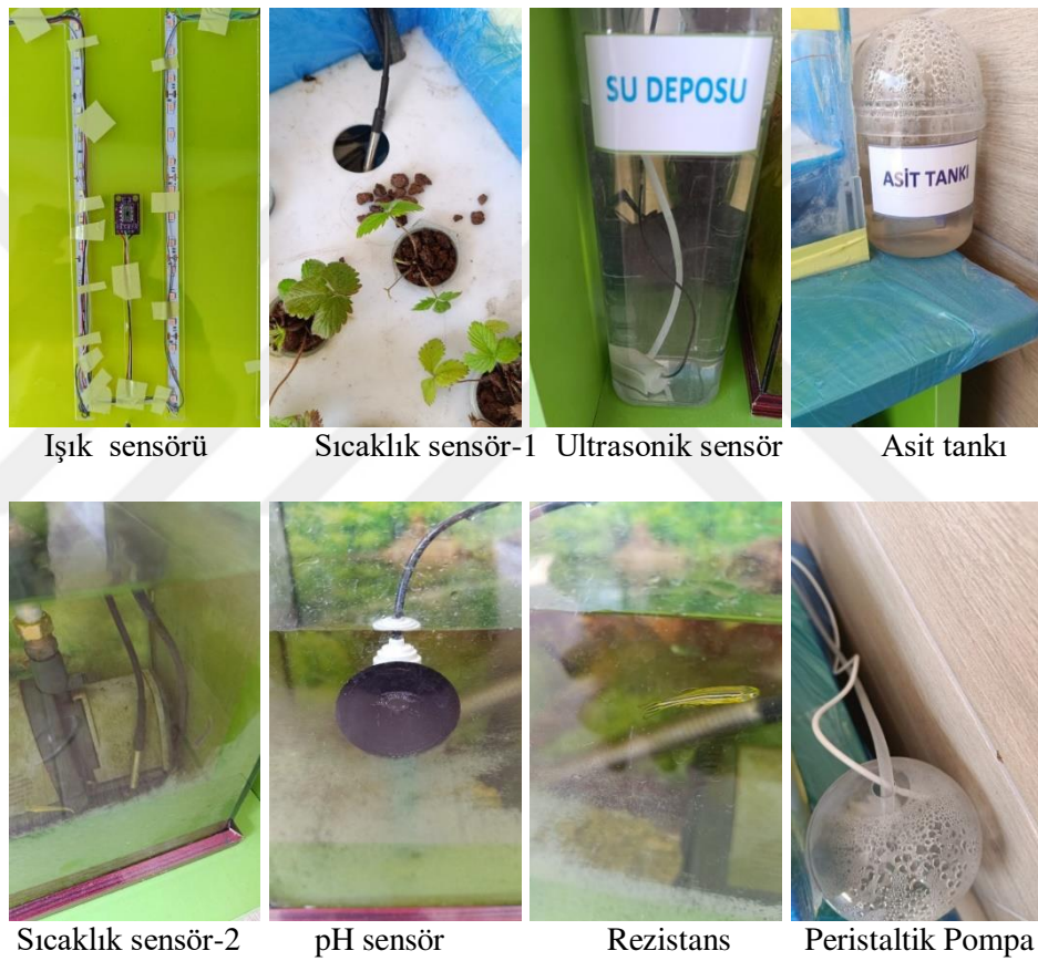
Şekil 4.7. Mobil Aquaponik Sistemin gerçek zamanlı sensör ölçümü
