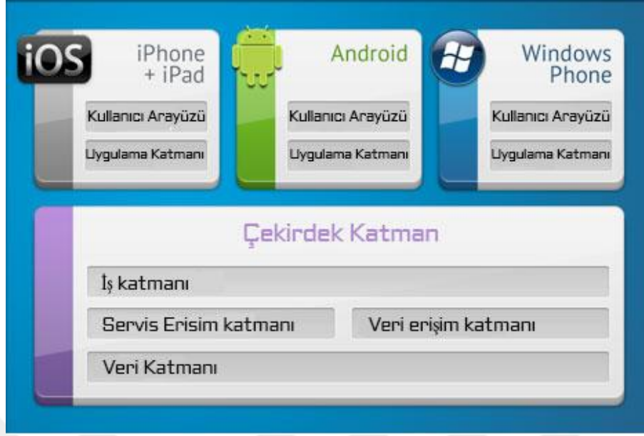
Şekil 3.12 Xamarin çalışma prensibi
