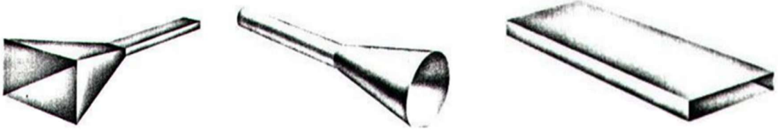
Şekil 3. 5 Sırasıyla piramit huni, konik huni ve dikdörtgen dalga kılavuzu açıklık anten yapıları (Balanis, 2016)
