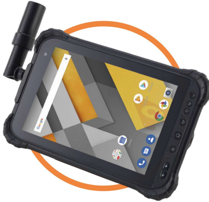
Şekil 4. 4 LT700H çift frekanslı Cors ve Rtk özellikli endüstriyel tablet (URL 21, 2024)
