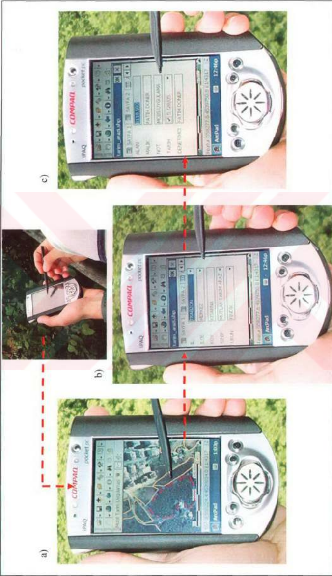
Şekil 19. Uygulama-2 ile toplanan veriler için arayüz örnekleri: a) IKONOS uydu görüntüsü üzerinde sayısallaştırılan tarım arazisini gösteren ArePad yazılımı arayüzü, b) ve c) Tarım arazisine ait öznitelik bilgilerinin girildiği veri tabanı arayüzleri
