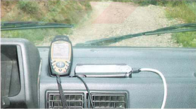
Şekil 22. El GPS'i ve cep bilgisayar entegre edilerek hareket halindeki araçla yol güzergahı tespiti
