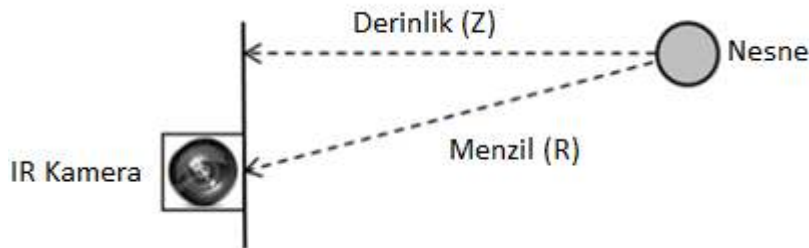
Şekil 5.13 Derinlik ölçümü (Z)’e karşı menzil (R) [47].
