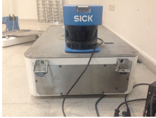
Şekil 4.5: Lazer sensörün robot üzerindeki konumu.
