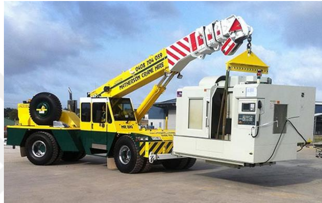
Şekil 3.16. Kaldır-götür tipi vinç kullanım örneği
