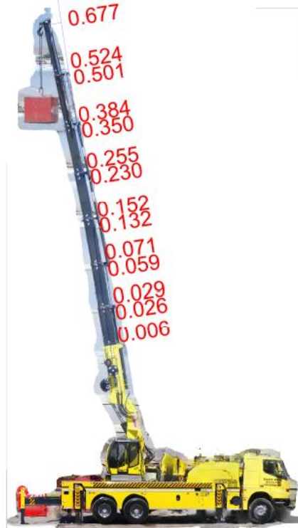
Şekil 4.23. Mobil vinçte 4100 kg yükteki 82° konumundaki sehimin oluşma görüntüsü
