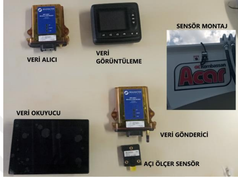
Şekil 3.43. Açı ölçer sensörleri kullanarak sehim ölçümü
