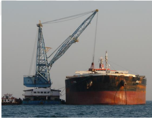
Şekil 3.20. Yüzer tipi vinç kullanım örneği
