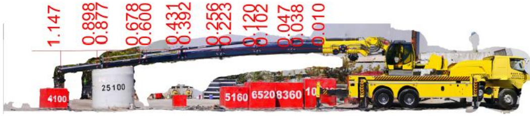
Şekil 4.10. Mobil vinçte 2500 kg yükteki yatay konumundaki sehimin oluşma görüntüsü
