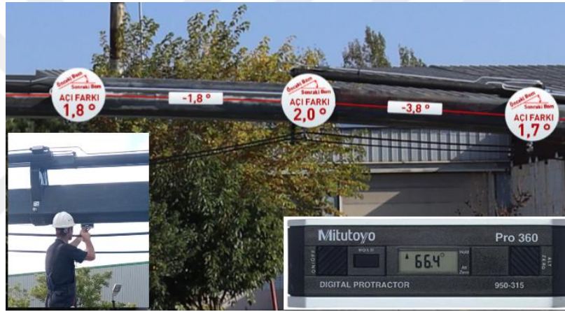
Şekil 3.42. Açı ölçer cihazları kullanarak sehim ölçümü
