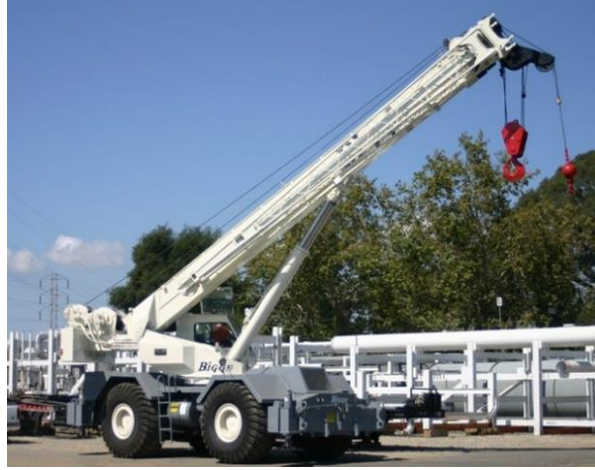
Şekil 3.14. Engebeli arazi tipi vinç kullanımı
