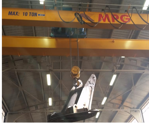
Şekil 3.2. 10 ton taşıma kapasiteli köprülü vinç
