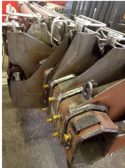
Şekil 3.25. Mobil vinç bom yapısı
