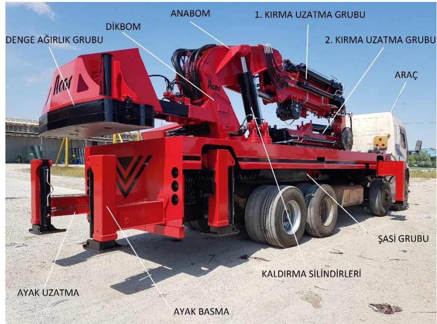
Şekil 3.22. Katlanır bomlu mobil hidrolik vinç ana bölümleri
