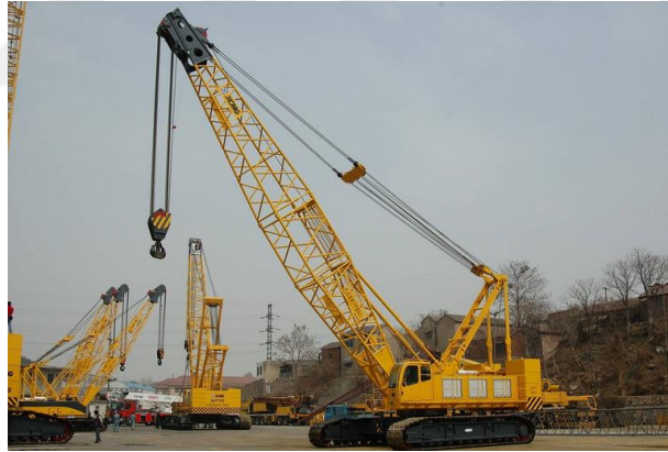
Şekil 3.18. Paletli vinç örneği
