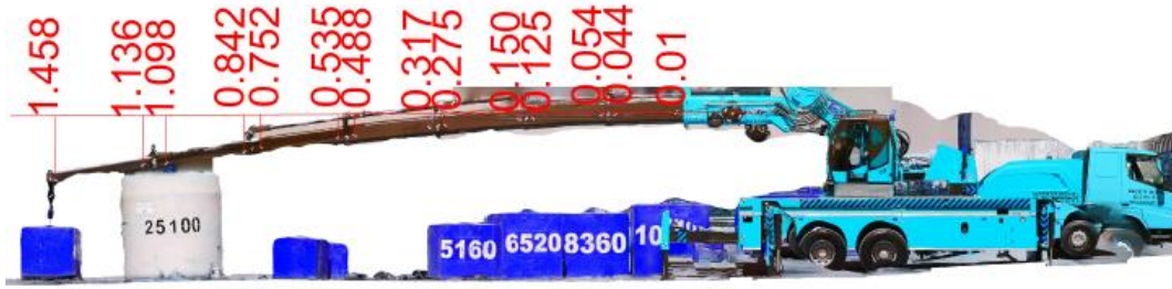
Şekil 4.11. Mobil vinçte 4100 kg yükteki yatay konumundaki sehimin oluşma görüntüsü
