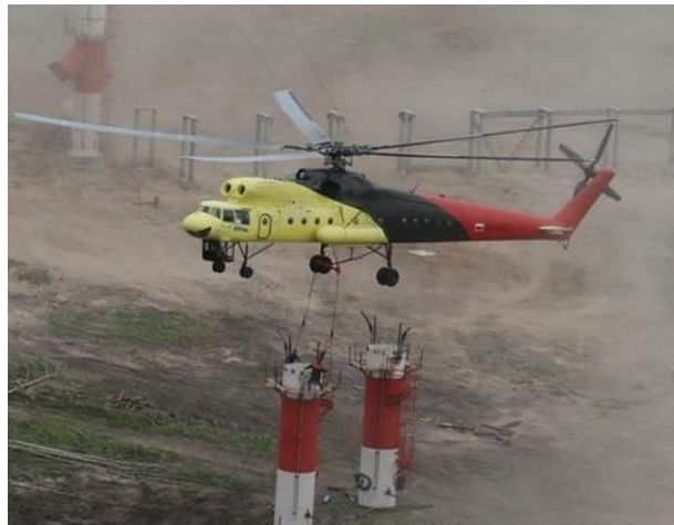
Şekil 3.12. Helikopter tipi vinç kullanımı örneği
