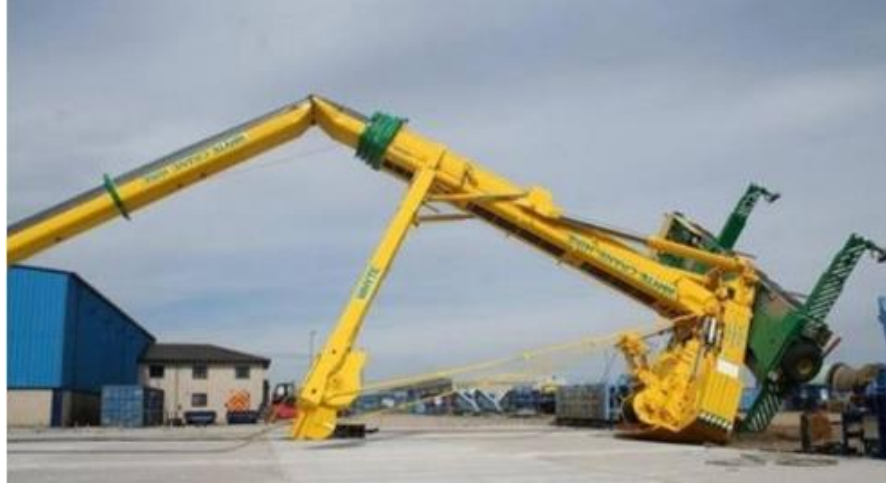
Şekil 3.29. Sehim nedeniyle meydana gelen mobil vinç devrilme kazası
