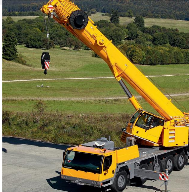
Şekil 3.15. Yol ve arazi tipi vinç örnek kullanımı
