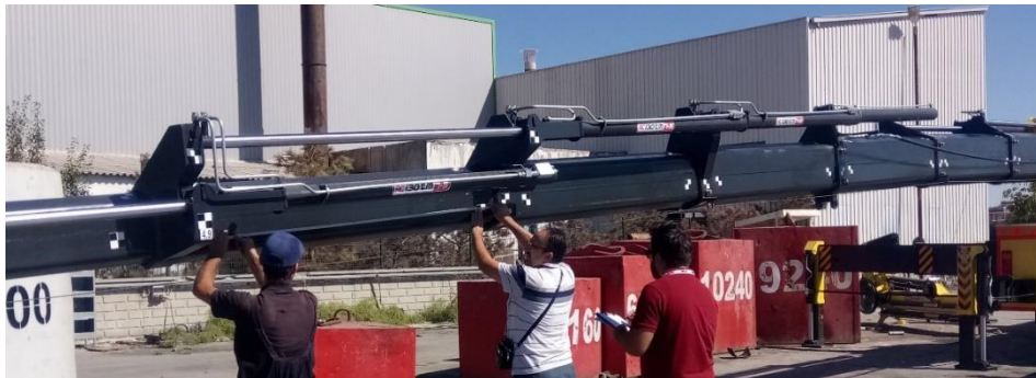
Şekil 4.2. Hedef noktalarının (marker) bom üzerine yerleştirilmesi
