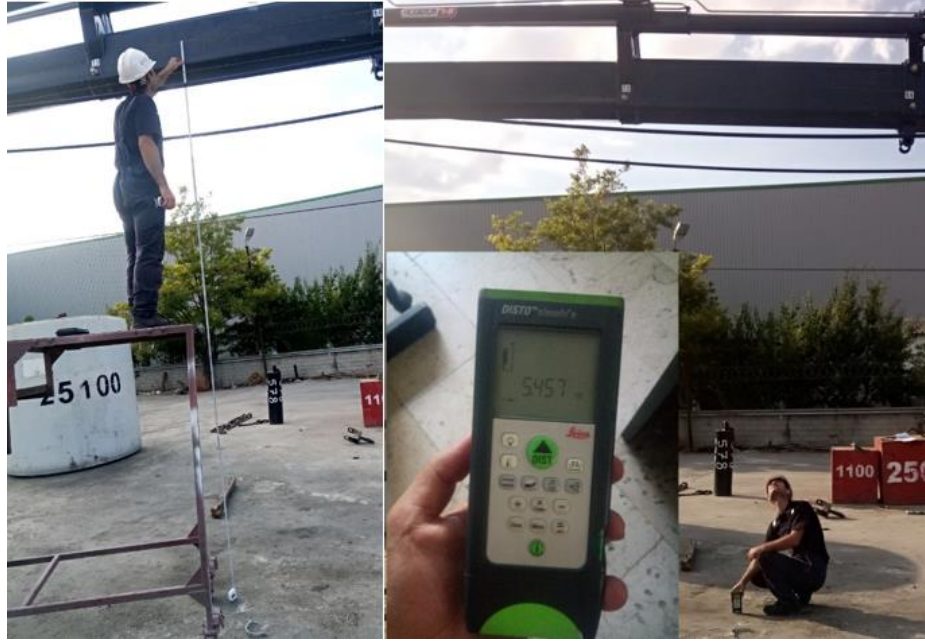
Şekil 3.41. Mobil vinç bomlarının çelik metre ve lazer ölçüm çalışması (MPG A.Ş. Mobil Vinç Test Alanı)
