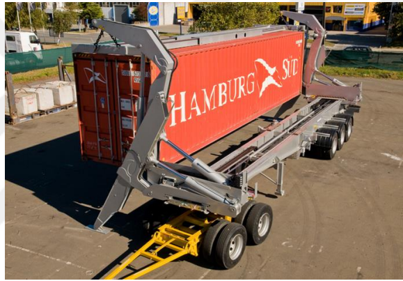
Şekil 3.13. Yandan kaldırıcı vinç yük kaldırma uygulaması
