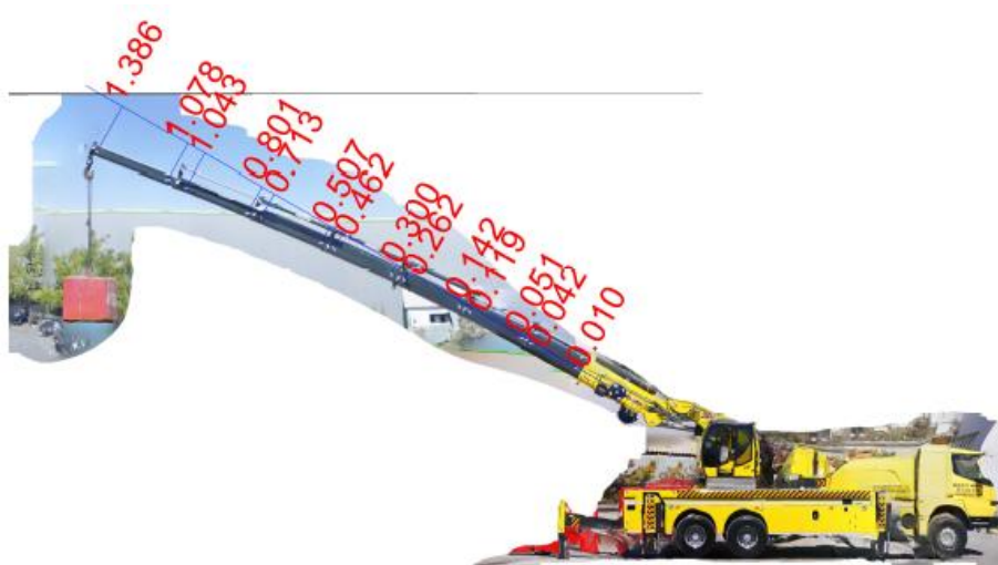
Şekil 4.15. Mobil vinçte 4100 kg yükteki 30° konumundaki sehimin oluşma görüntüsü
