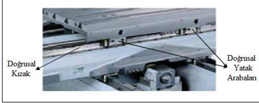
Şekil 2.5. Endüstriyel CNC tezgahlarda kullanılan doğrusal yataklar
