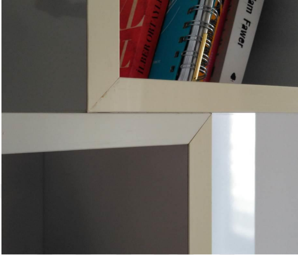
Şekil 2.10. Farklı kenar bantlarının aynı üründe kullanımı sonucu oluşan renk farklılığı [Fotoğraf: Burak Mirac Yılmaz, 2018]
