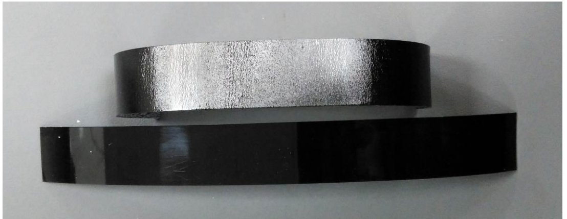
Şekil 4.10. 1S Numunesi Boyutsal Kararlılık Deney Sonu Durumu [Fotoğraf: Burak Mirac Yılmaz, 2018]
