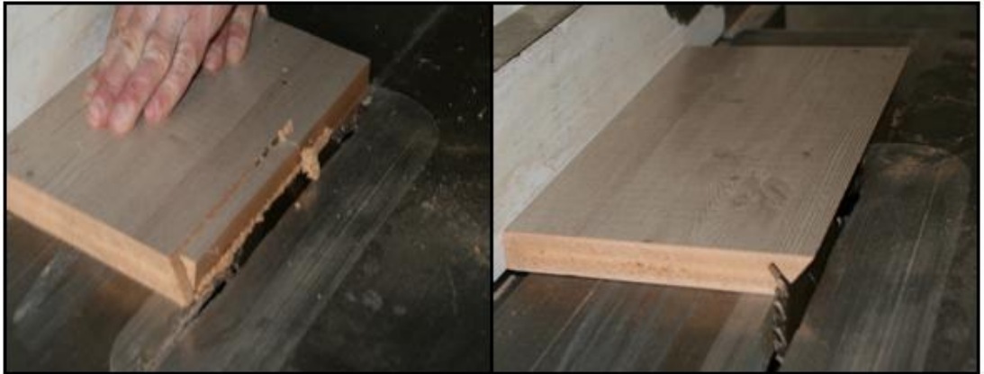
Resim 3.4. Yabancı çıtalı 45° gönye burun birleştirme
