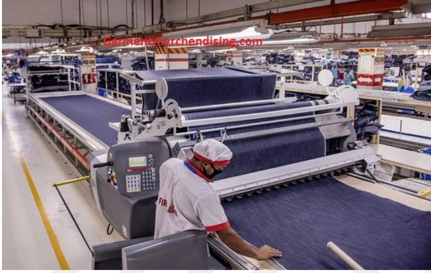
Resim 2.4. Bir giyim fabrikasında kumaş yayma işlemi https://garmentmerchandising.com/fabric-spreading-process-in-apparel/ 06.11.2021 tarihinde erişilmiştir.
