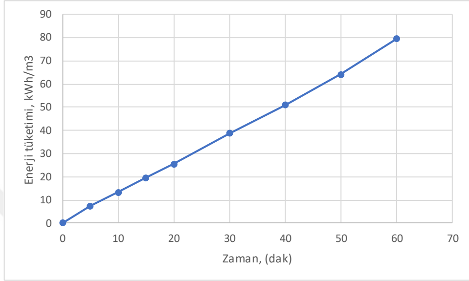
Şekil 5.48. Enerji tüketimi – zaman ilişkisi ( I=2,5 A, i=25 mA/cm 2 , 10 mM Na 2 SO 4 , 3 mg/L H 2 O 2 (1,5-1,5mg/L), 0,05 g MnO 2 )
