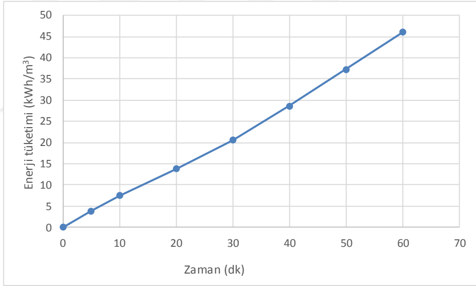
Şekil 6.42. Enerji tüketimi – zaman ilişkisi ( I=2 A, i=20 mA/cm 2 , 10 mM Na 2 SO 4 , 2500 mg/L H 2 O 2 )
