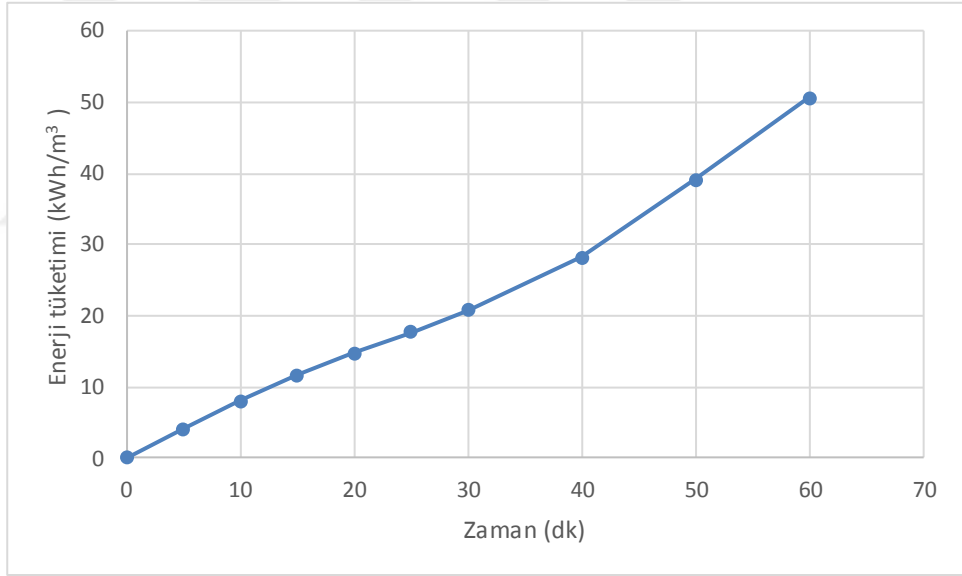
Şekil 6.12. Enerji tüketimi – zaman ilişkisi ( I=2,5A , i=25 \text{ mA/cm}^2 ve 10 \text{ mM Na}_2\text{SO}_4 )
