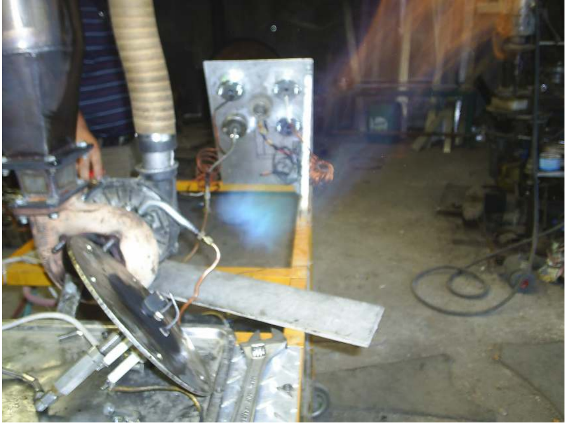
Resim 5.27. Yakıt vanası tam açık konumda iken alev boyu
