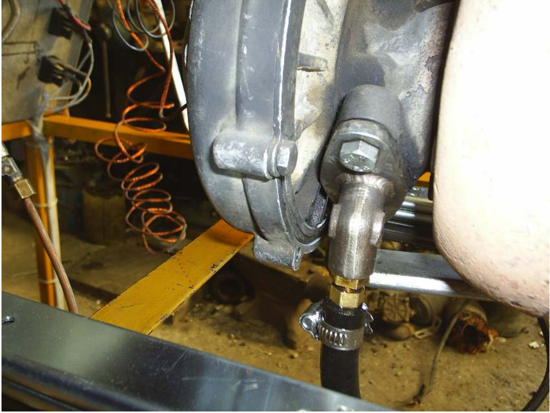
Resim 5.35. Eğimli hale getirilmiş yağ çıkış kısmı
