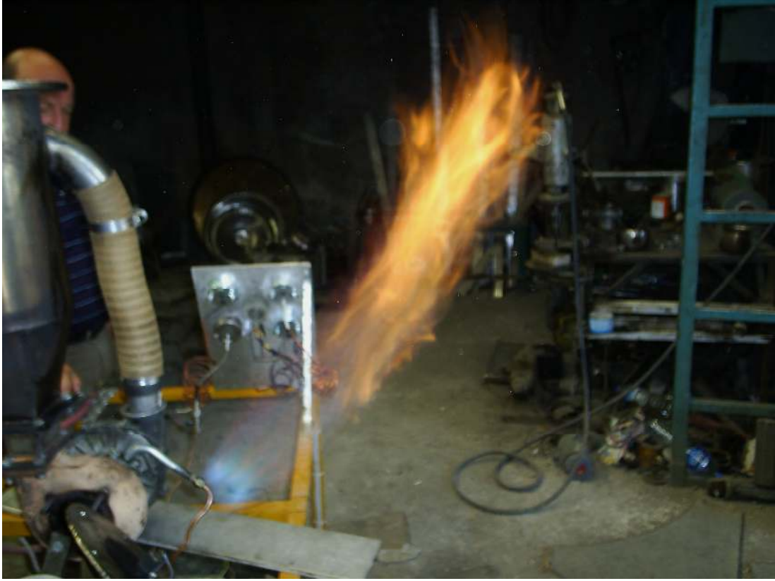
Resim 5.26. Yakıt vanası yaklaşık yarı açık konumda iken alev boyu
