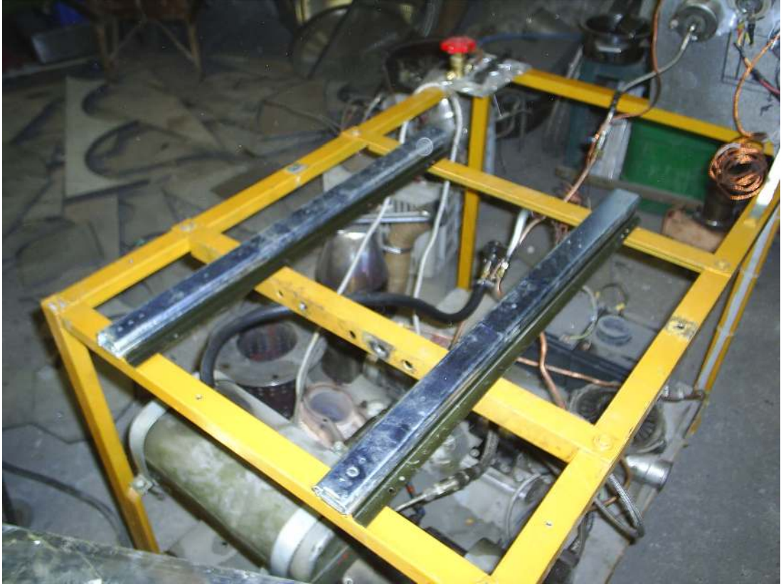
Resim 5.41. Kızakların şase üzerine monte edilmiş hali
