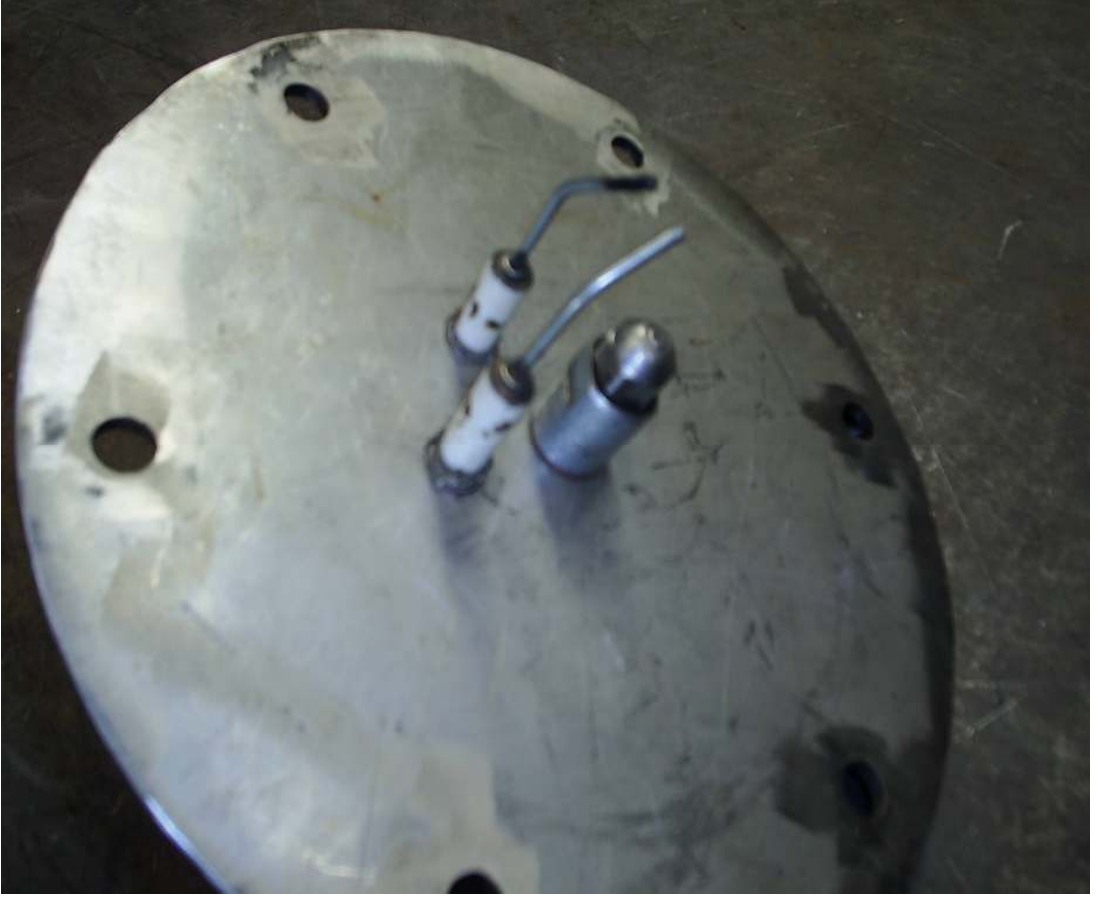
Resim 5.23. Enjektör memesi takılı ve 2 mm'ye genişletilmiş halde iken enjektörün görünümü
