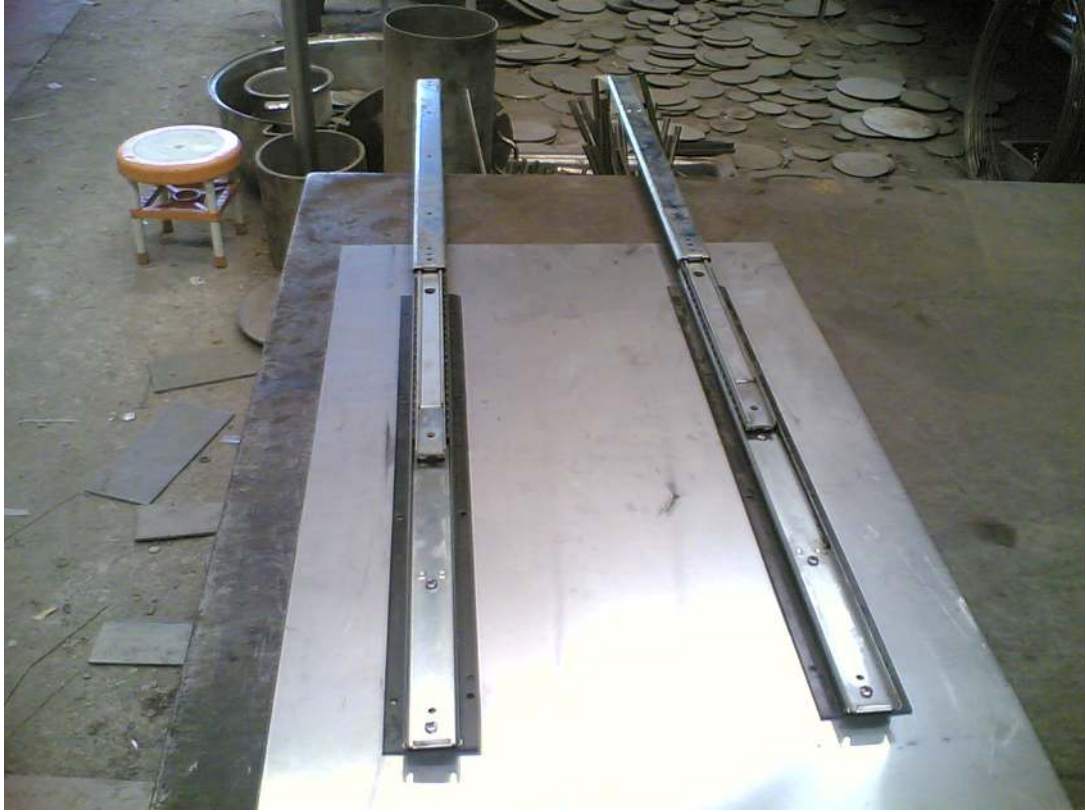
Resim 5.40. İç içe geçmiş üç adet kızak ve teleskopik açılım
