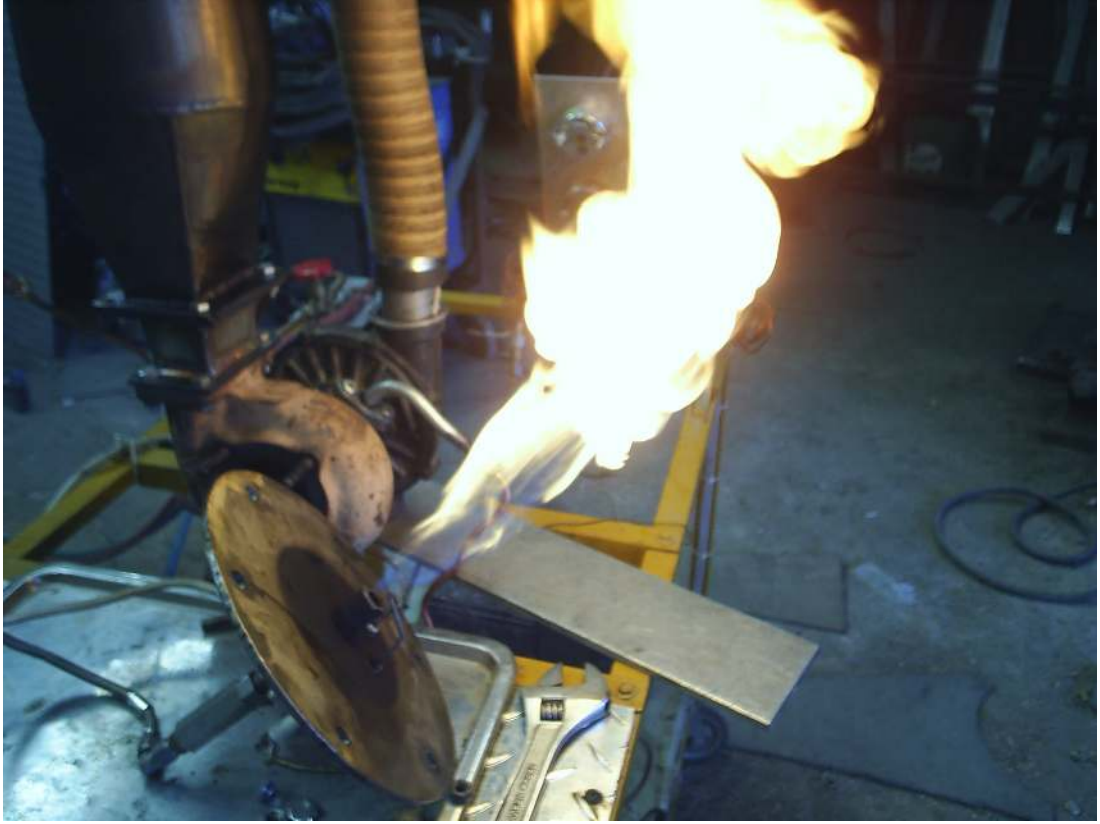
Resim 5.25. Yakıt vanası kısık durumda iken alev boyu
