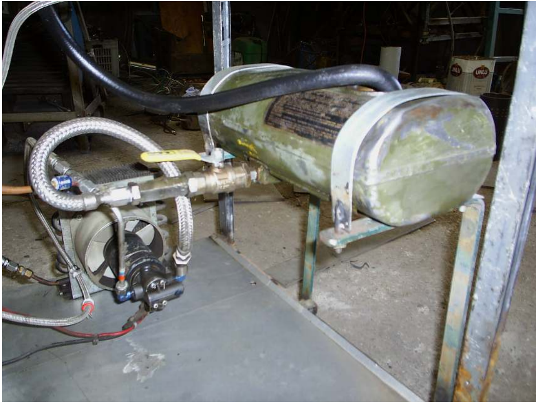
Resim 5.32. Yağ deposuna monte edilmiş olan vana
