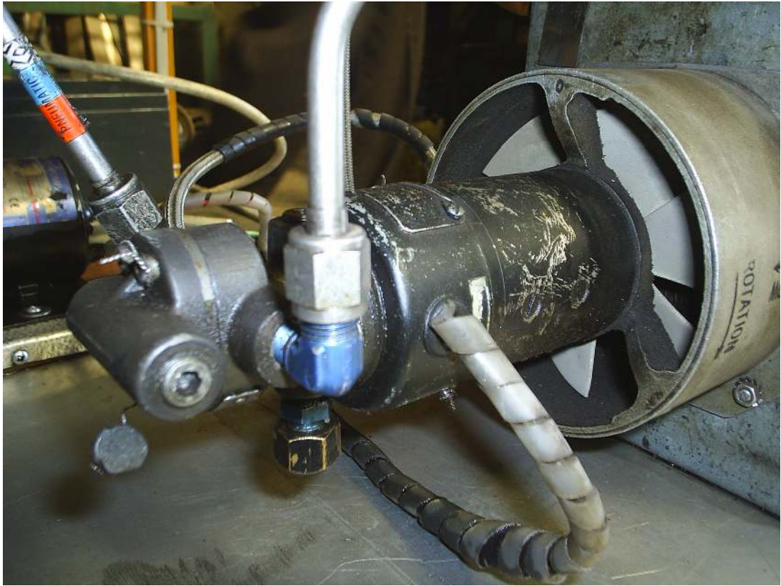
Resim 5.30. Hem yağ pompası hem soğutucu fan özelliği
