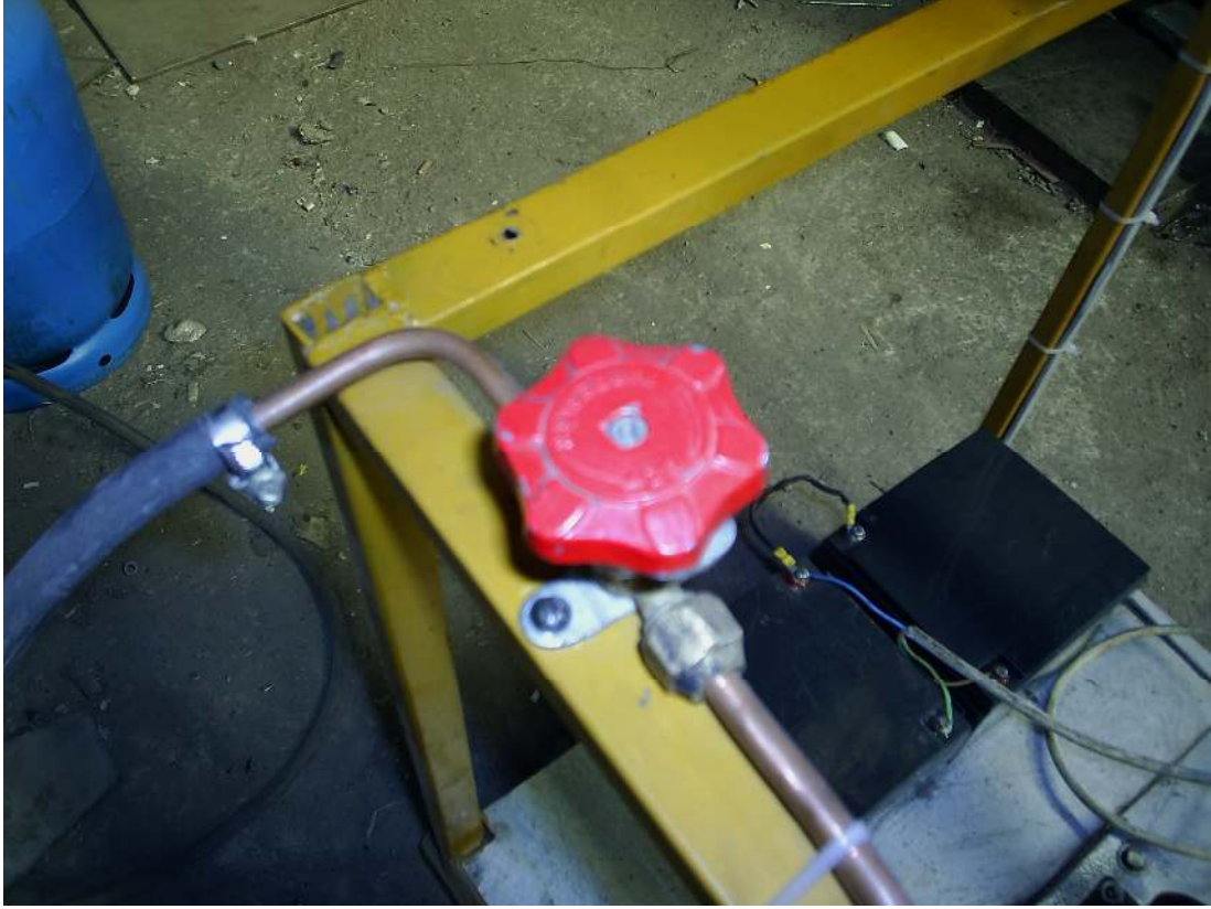
Resim 5.28. Sisteme giren yakıtı artırıp azaltmak için kullanılan vana
