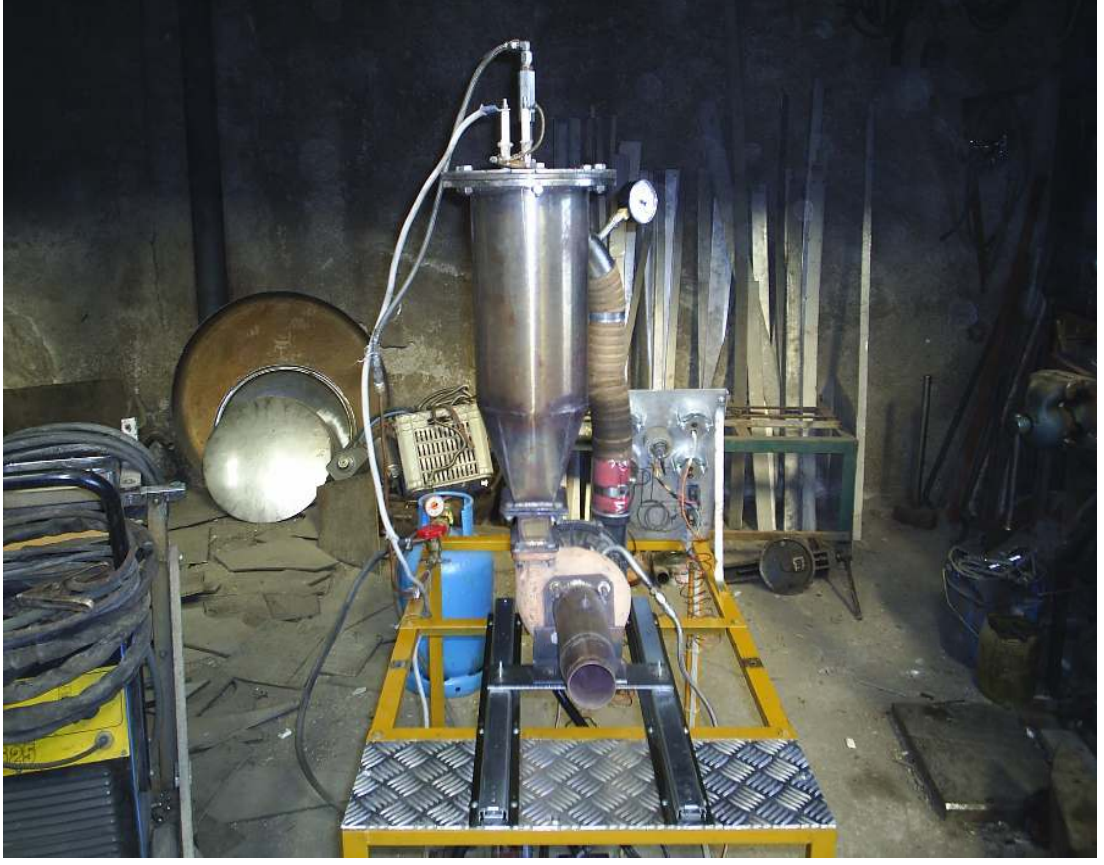
Resim 5.43. Kızak üzerine monte edilmiş turboşarjör, egzoz ve yanma odası
