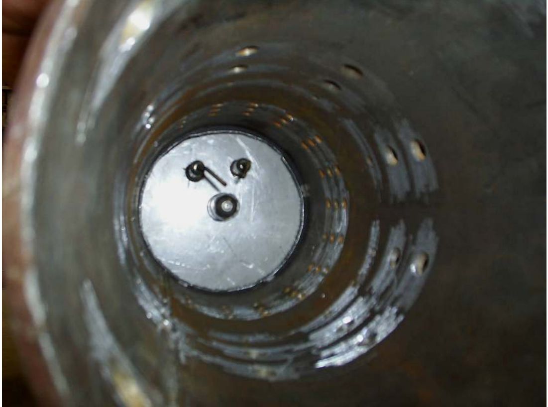
Resim 5.22. Buji ve enjektörün alev tüpü içindeki konumları
