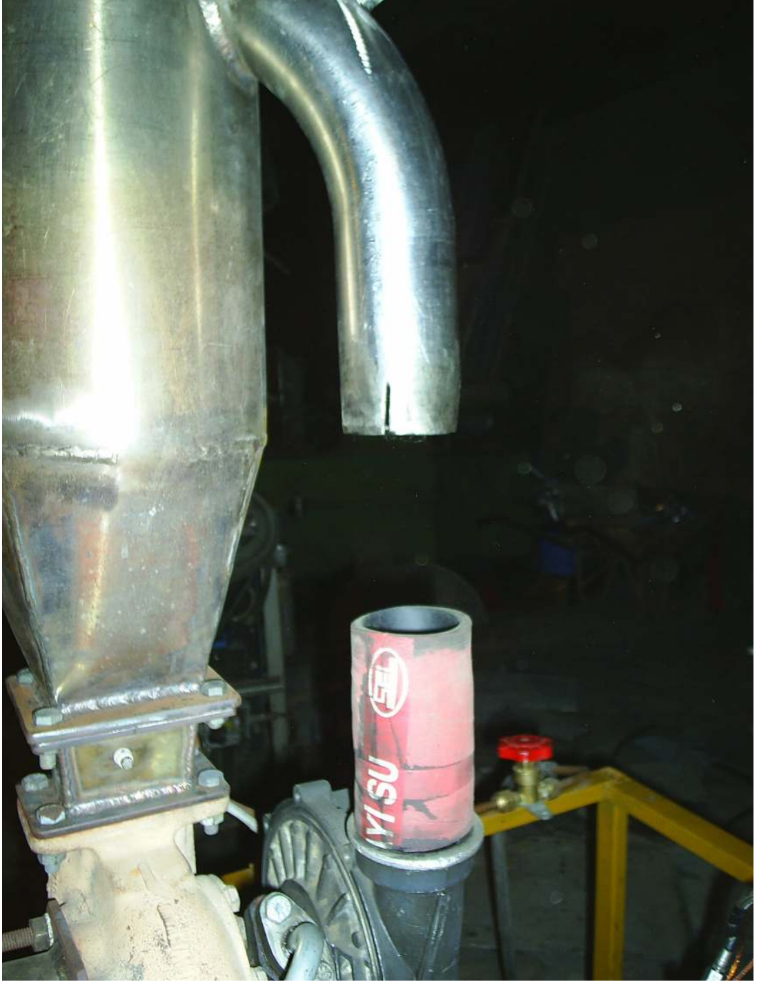
Resim 5.15. Yanma odasına dıştan kaynatılan hava borusu
