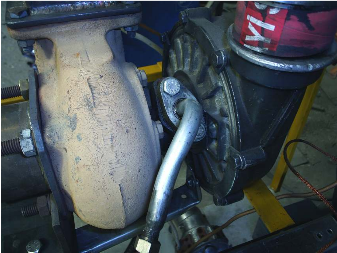
Resim 5.33. Turboşarjörün yağ giriş kısmı
