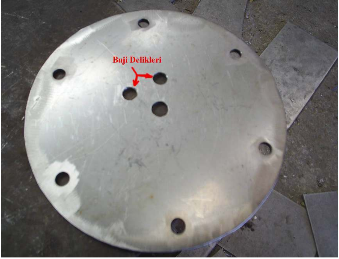
Resim 5.21. Buji elektrotlarının bağlandığı flanş ve üzerindeki bağlantı delikleri
