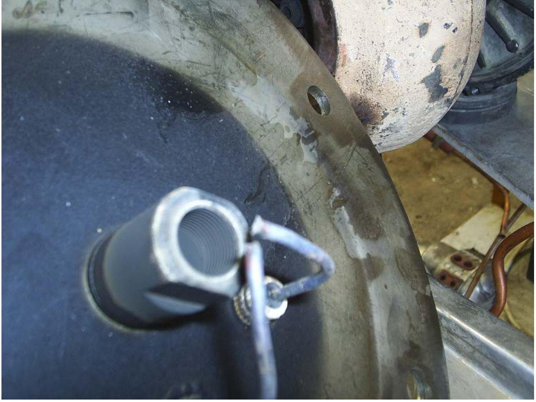
Resim 5.24. Enjektör memesinin çıkarılmış hali ve buji elektrotları
