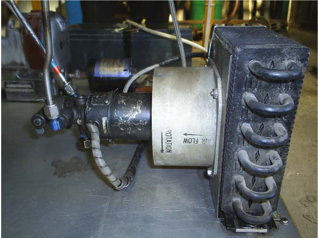
Resim 5.36. Yağ pompasının fan kısmına eklenmiş olan radyatör
