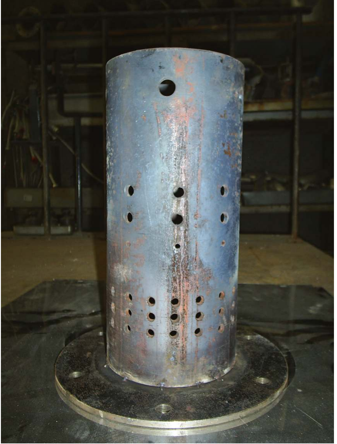
Resim 5.9. Yapımı bitmiş alev tüpü
