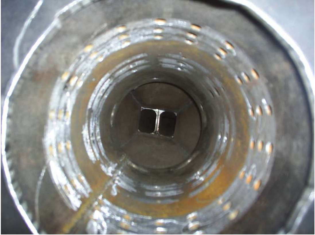
Resim 5.14. Alev tüpü yanma odası içinde iken redüksiyonun görünümü
