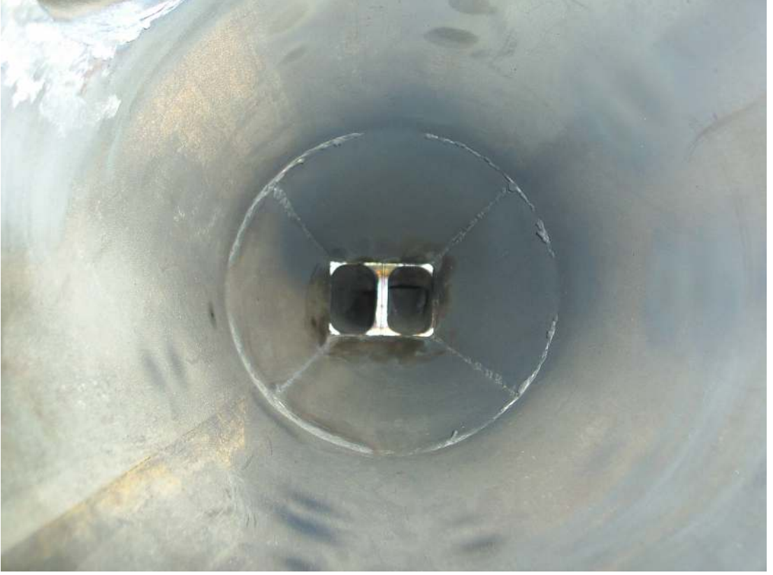
Resim 5.13. Yanma odasından türbin salyangozuna geçişteki redüksiyon
