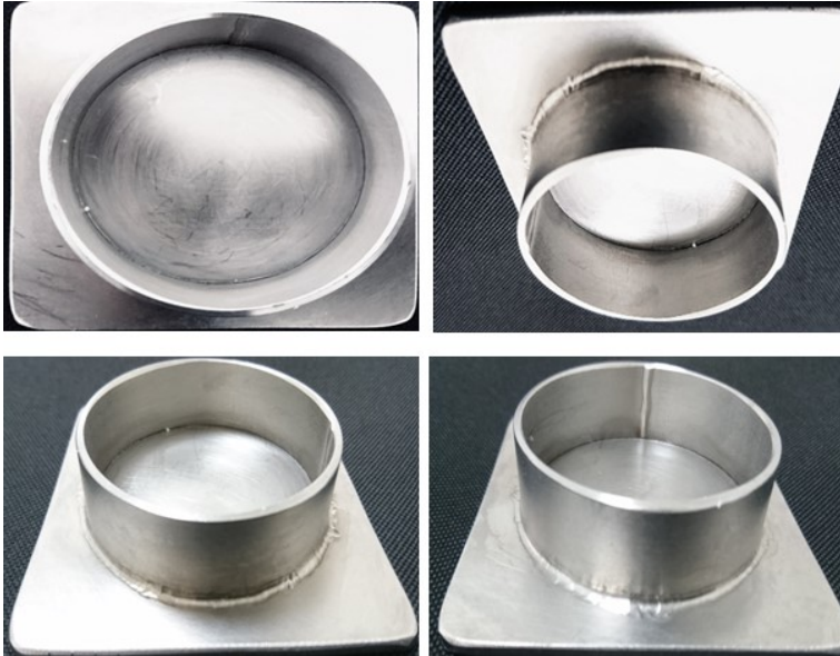
Şekil 3.2. Tek tabakalı filmlerin elde edildiği 57 mm çaplı kalıplar
