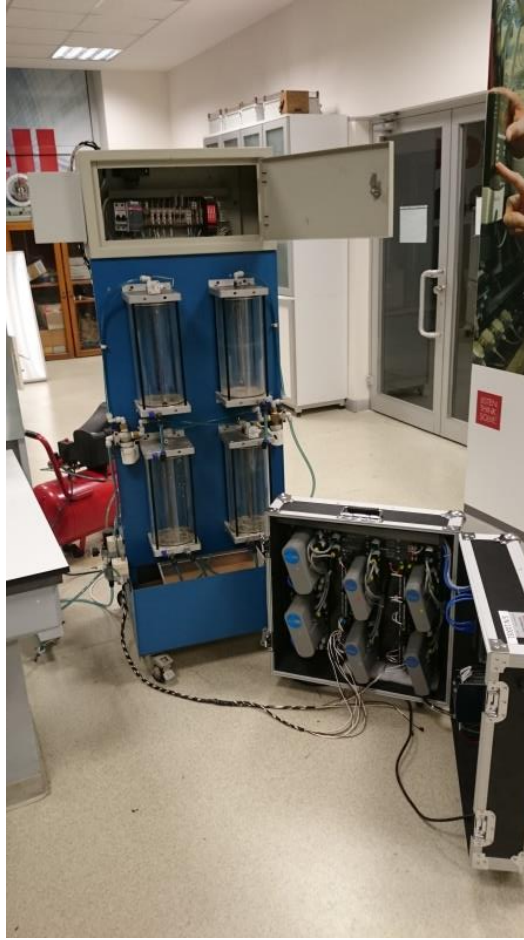
Şekil 5.1 : 4 Tank sıvı seviye kontrol düzeneği.
