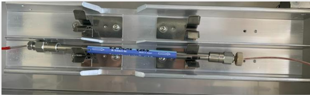
Şekil 3.19: LC-MS/MS cihazına yerleştirilmiş C18 Ters Faz Kolonu.
