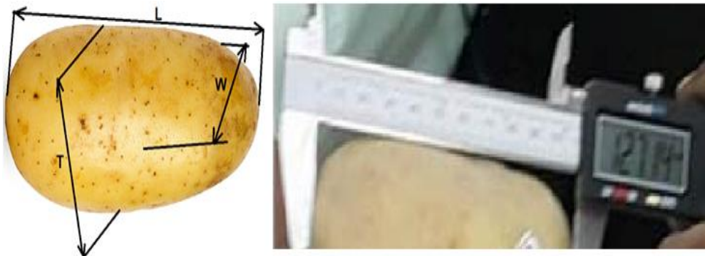
Figure : 6 Positionnements des trois axes de mesure de la pomme de terre
