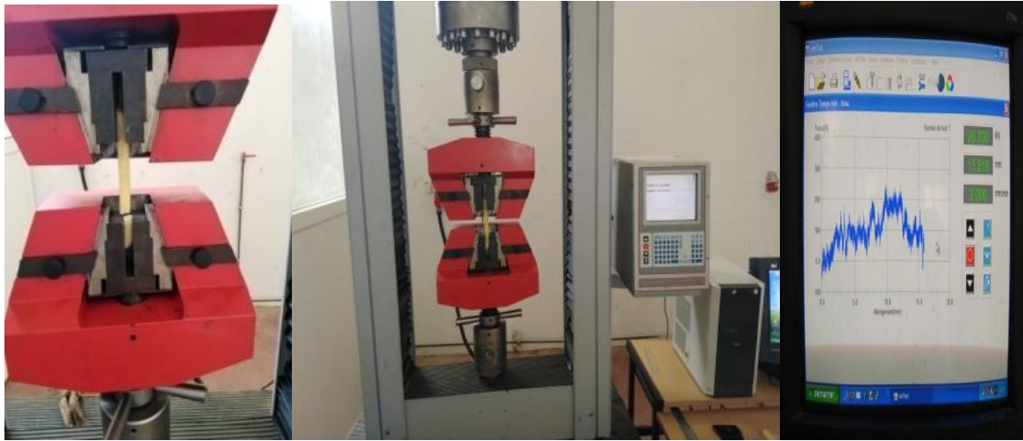
Figure : 29 Fixation de l'éprouvette et déroulement de l'essai de tractions
