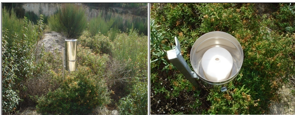
Figura 4.2. Pluviómetro instalado na zona do aquífero da água de nascente Fonte da Fraga: a) Aspecto geral do pluviómetro; b) Interior do pluviómetro.
