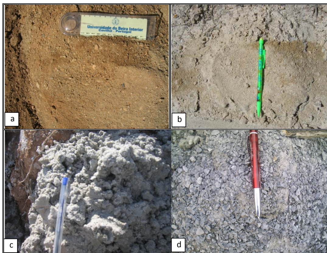
Figura I.3. Imagens típicas dos “cuttings” de perfuração de: a) xisto argiloso W5; b) granito W4/W5; c) granito W1/W2; d) corneana W1/W2, do novo furo MF1 do sector principal do aquífero de água de nascente Fonte da Fraga.
