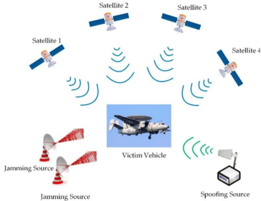
Şekil 3.4. Jamming ve spoofing özet diyagramı
