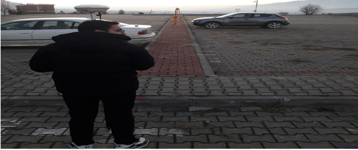
Şekil 4.12. 25 metre mesafeden uygulanan jamming ve spoofing uygulama işlemi
