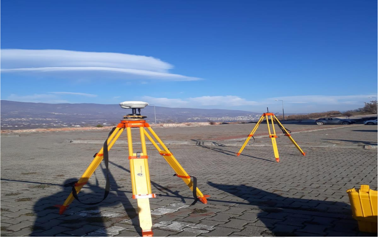
Şekil 4.10. 5 metre mesafeden uygulanan jamming ve spoofing uygulama işlemi
