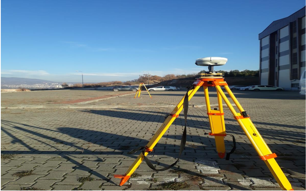
Şekil 4.11. 15 metre mesafeden uygulanan jamming ve spoofing uygulama işlemi
