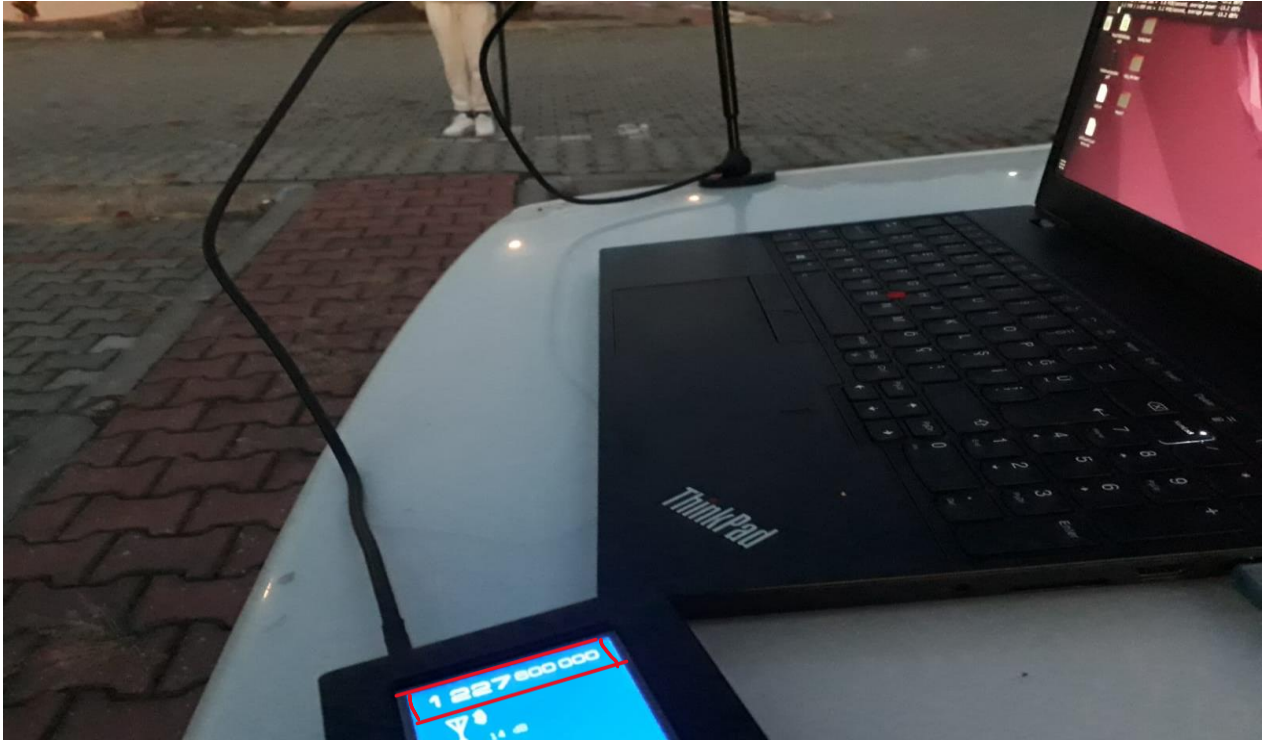
Şekil 4.9. GPS L2 frekansına(1227 MHz) jamming ve spoofing uygulama işlemi
