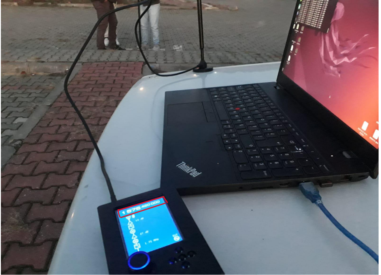
Şekil 4.8. GPS L1 frekansına(1575 MHz) jamming ve spoofing uygulama işlemi
