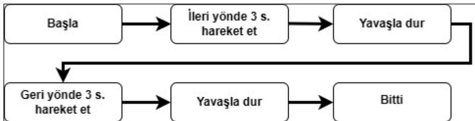
Şekil 3.17. Ön prototip mobil robot 1 sıra hareket denemesi akış diyagramı
