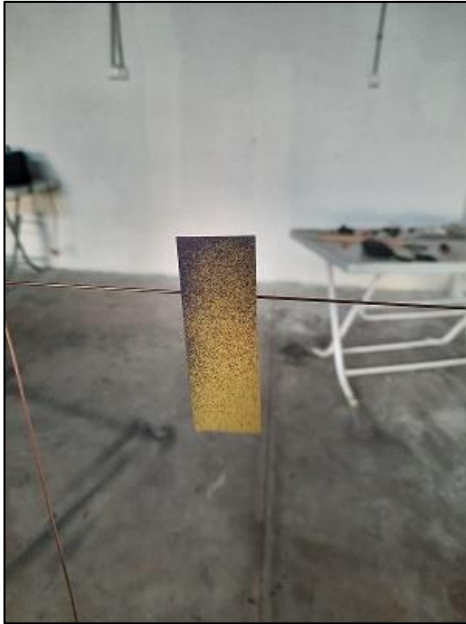
Şekil 4.9. Tele asılmış suya duyarlı kağıdın ilaçlama sonrası görüntüsü
