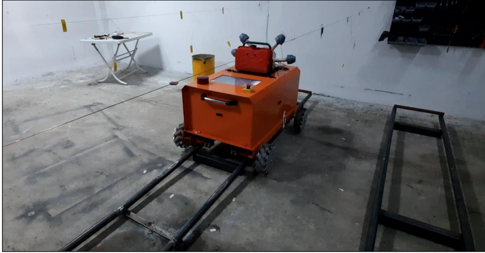
Şekil 4.8. Mobil robotun denemeler sırasında ULV tipi pülverizatör ile çalışması
