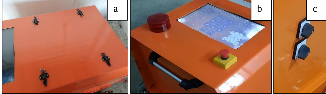
Şekil 3.5. a) Gergi mandalları b) Monitör, acil stop butonu, siren ve tutamaç c) pako şalterler
