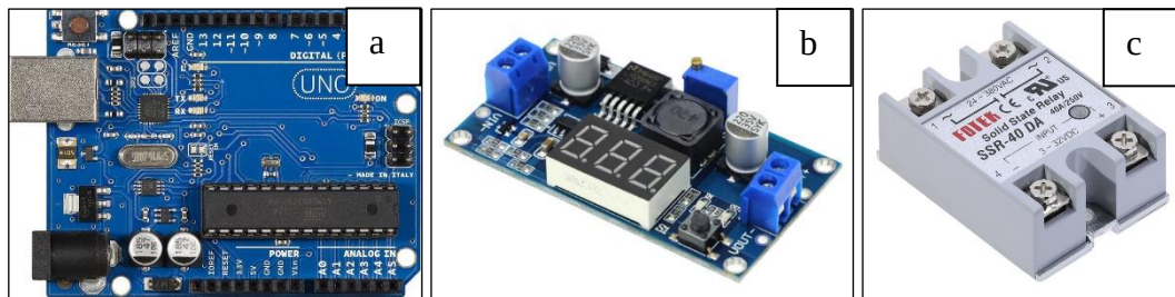
Şekil 3.10. a) Arduino UNO b) Ayarlanabilir 3 A voltaj regülatörü c) SSR röle
