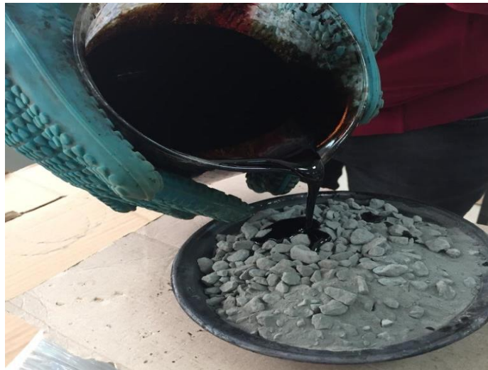
Şekil 37. Gradasyona göre hazırlanan agregaya bitümün ilave edilmesi
