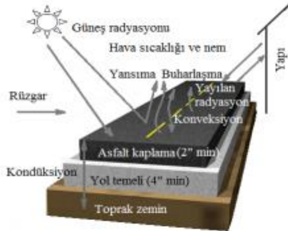
Şekil 14. Asfalt yol üzerindeki ısı dengesi (Şevik, 2016)
