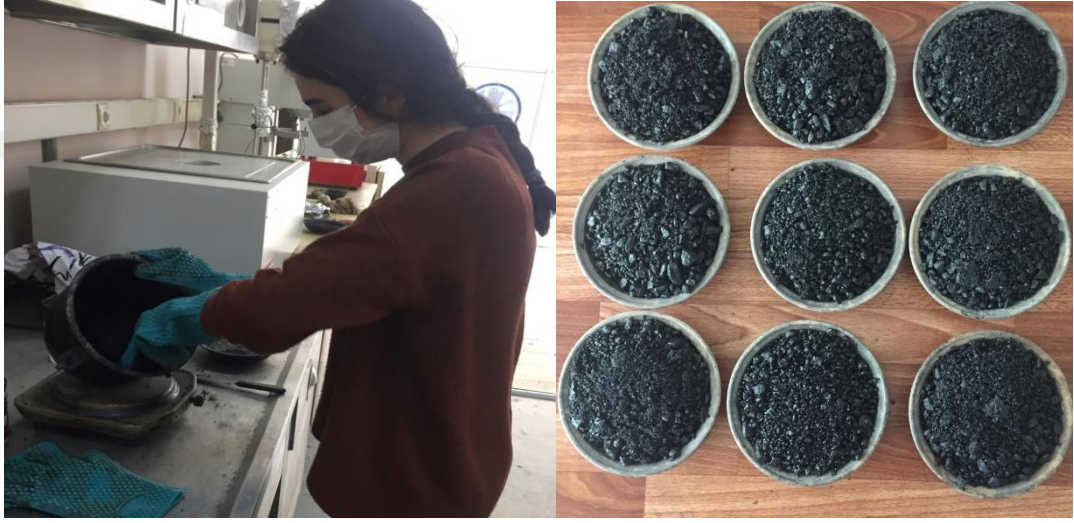
Şekil 38. (a) Malzemelerin karıştırılması, (b) oluşturulan karışımın kaplara yerleştirilmesi
