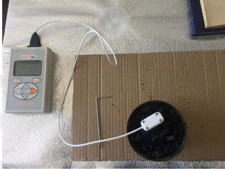
Şekil 40. Numunelerin termal iletkenliğinin ölçülmesi
