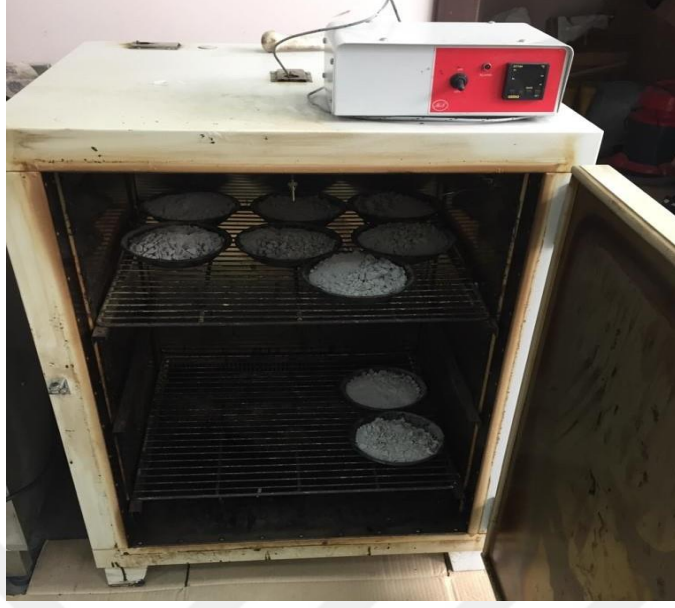
Şekil 36. Hazırlanan agregaların etüve yerleştirilmesi
