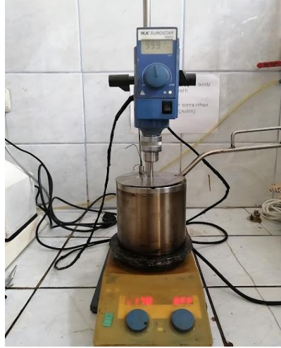
Şekil 4.6. Mekanik karıştırıcı ile modifiyeli bağlayıcı hazırlama işlemi
