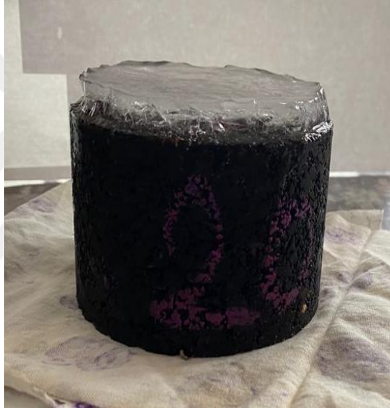
Şekil 4.27. Buz eritme deneyi için örnek
