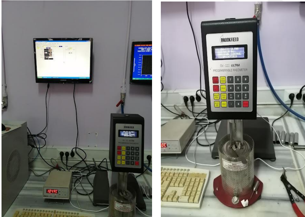
Şekil 4.11. Dönel viskozimetre (RV) deneyinin yapılışı
