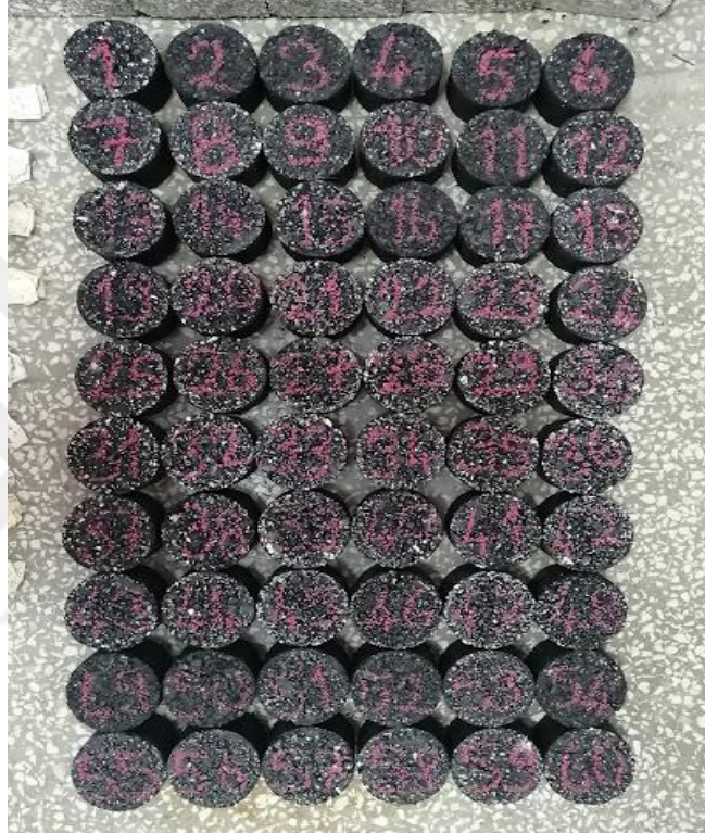
Şekil 5.16. Nem hasarı deneyine tabi tutulan numunelerin bir kısmının görünüşü
