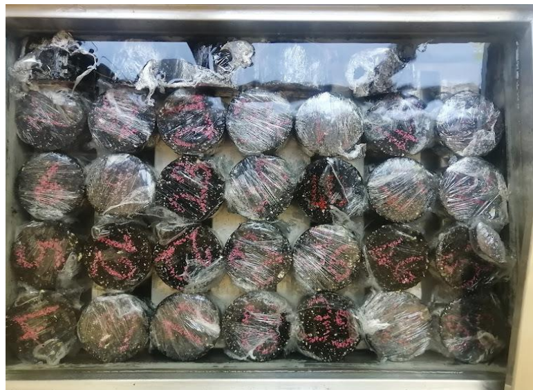
Şekil 4.16. Numunelerin streç film ile sarılıp bekletilmesi
