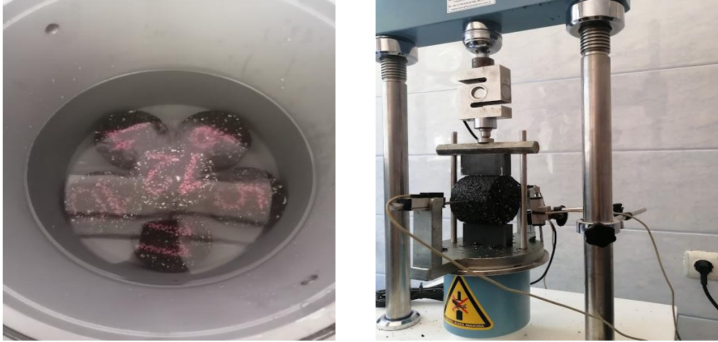
Şekil 4.17. Vakum işlemi ve nem hasarına karşı dayanım deneyi
