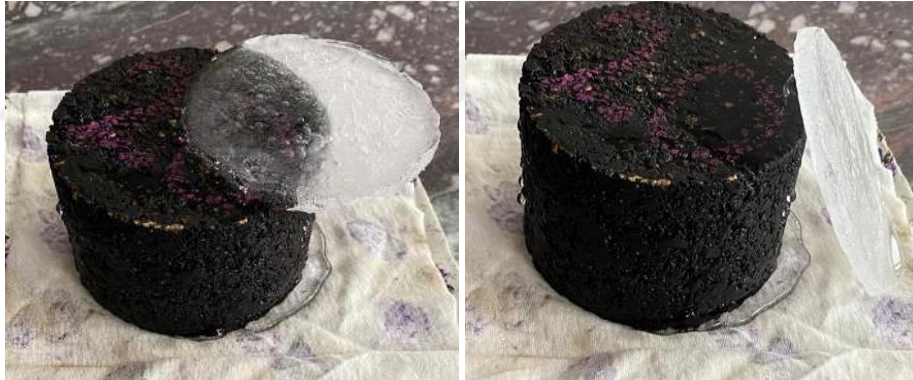
Şekil 5.45. 5mm kalınlığında buz içeren 3CMS10 karışımının indüksiyon ısıtmalı buz eritme sonucu
