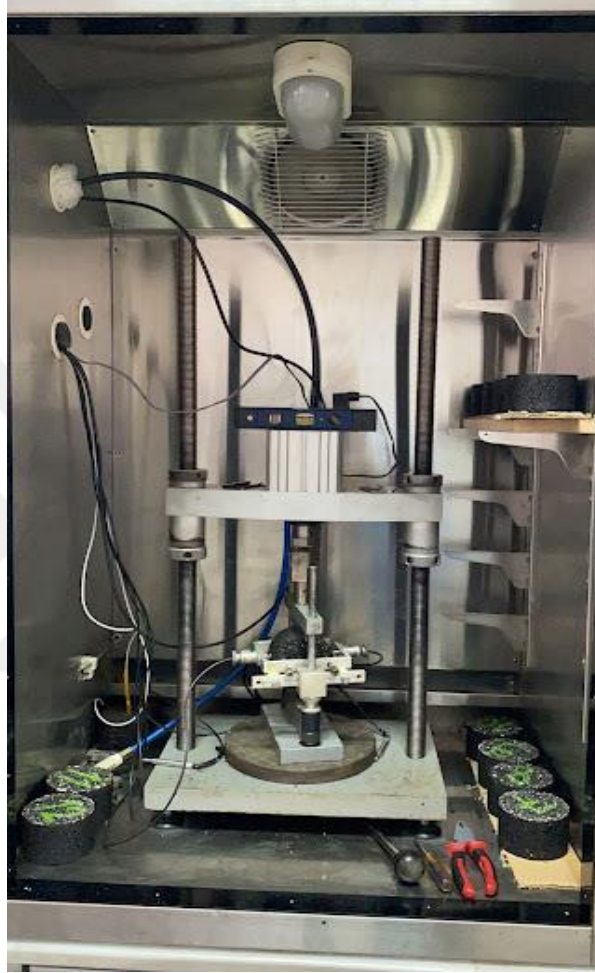
Şekil 4.18. İndirekt çekme rijitlik modülü deneyinin yapılışı
