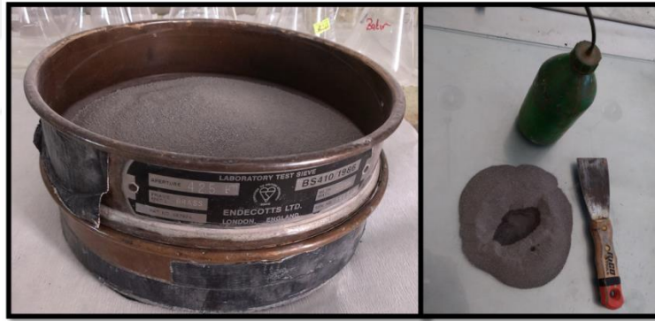
Şekil 3.16. 40 no'lu elekten (0,425 mm) numunenin elenmesi ve numunenin su ile homojen olarak karıştırılması
