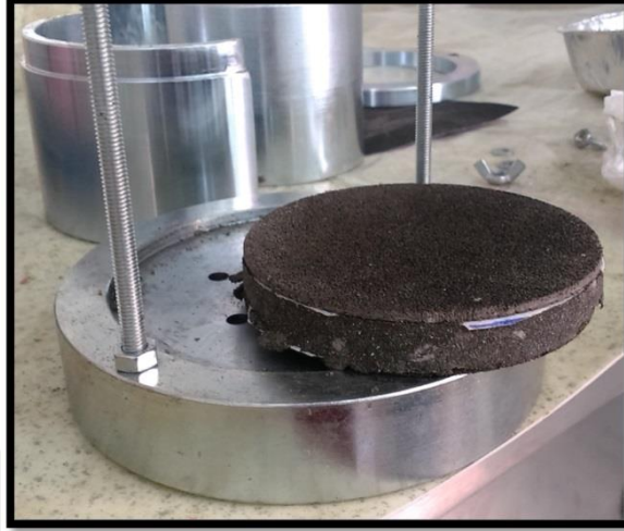
Şekil 3.15. Hidrolik iletkenlik deney sonunda kalıptan çıkarılan sıkıştırılmış şilte görüntüsü
