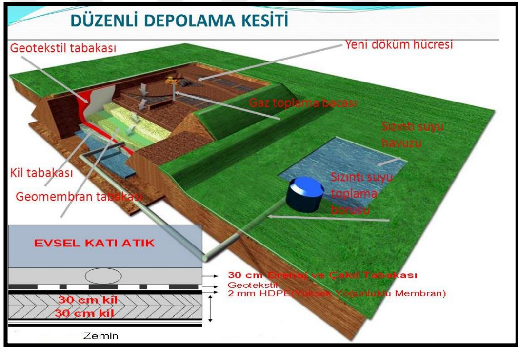
Şekil 2.5. Düzenli Depolama Tesisinin Kesiti (Anonim 2017c)
