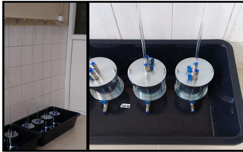
Şekil 3.21. Deneylerimizde kullanılan hidrolik iletkenlik deney düzeneği
