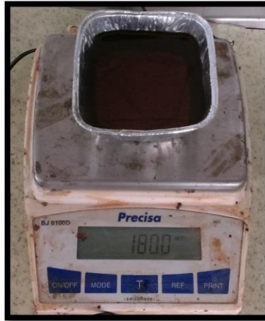
Şekil 3.6. %15 LABSA ile malzeme üretimi için tartılan 180 gr LABSA ve %20 SLES ile malzeme üretimi için tartılan 240 gr SLES
