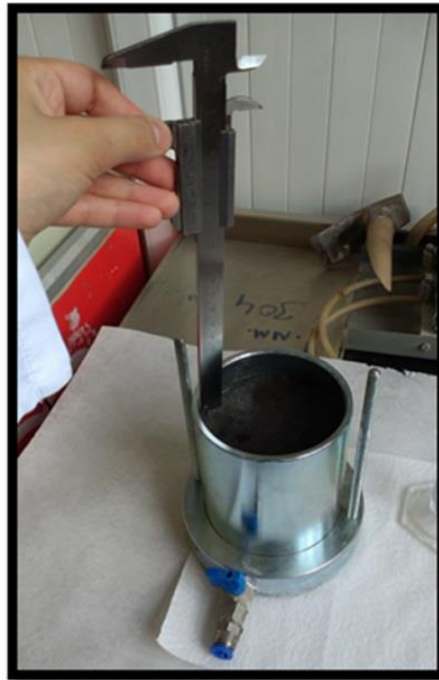
Şekil 3.11. Hidrolik iletkenlik deney kalıplarında belirli bir yükseklik oluşturulduktan sonra yukarıda kalan mesafenin kumpas ile ölçülmesi
