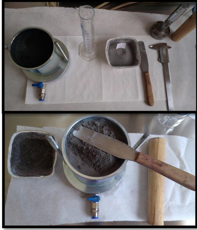
Şekil 3.13. Malzemenin geçirimlilik kalıbına yerleştirilmesi
