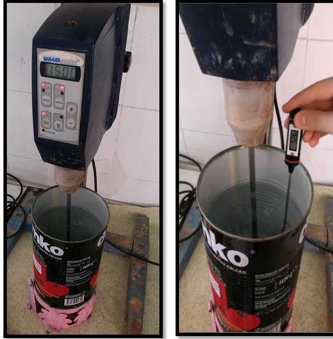
Şekil 3.3. İçerisine sıcaklığı ayarlanmış 3 lt su ilave edilen karıştırma kabının ısıtıcı üzerinde mekanik karıştırıcıda 1500 devir/dakikada karıştırılması
