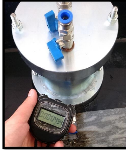
Şekil 3.24. Deney okumalarının kararlı akım sağlandıktan sonra farklı aralıklarda yapılması
