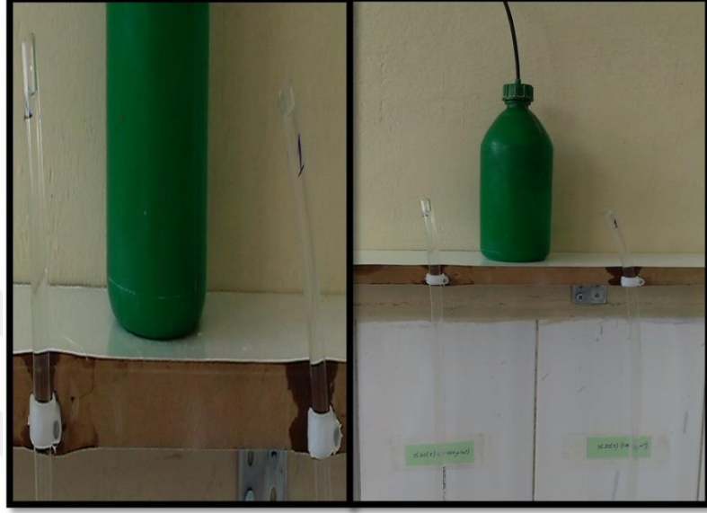
Şekil 3.22. Şeffaf boru üst sınır noktasına kadar su ile doldurulması
