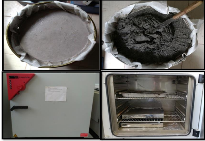
Şekil 3.8. Malzemenin filtre edildikten sonra karıştırılarak 50°C etüve konulması
