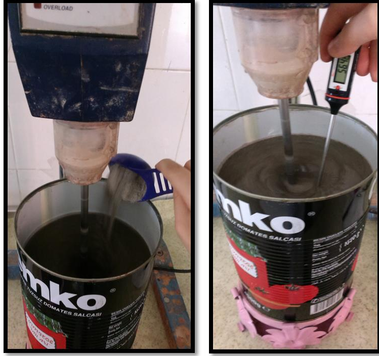
Şekil 3.4. Suyun içerisine uçucu külün ilave edilmesi ve sıcaklığın kontrol edilmesi
