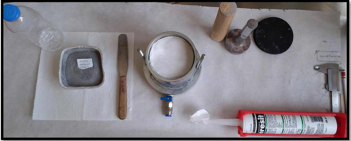
Şekil 3.20. Optimum su muhtevasında hazırlanan numunenin kompaksiyon kalıbına yerleştirilmesi
