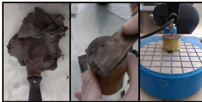
Şekil 3.17. Hazırlanan numunenin metal deney kaba sıkıca ve içinde hava kabarcığı kalmayacak şekilde yerleştirilmesi
