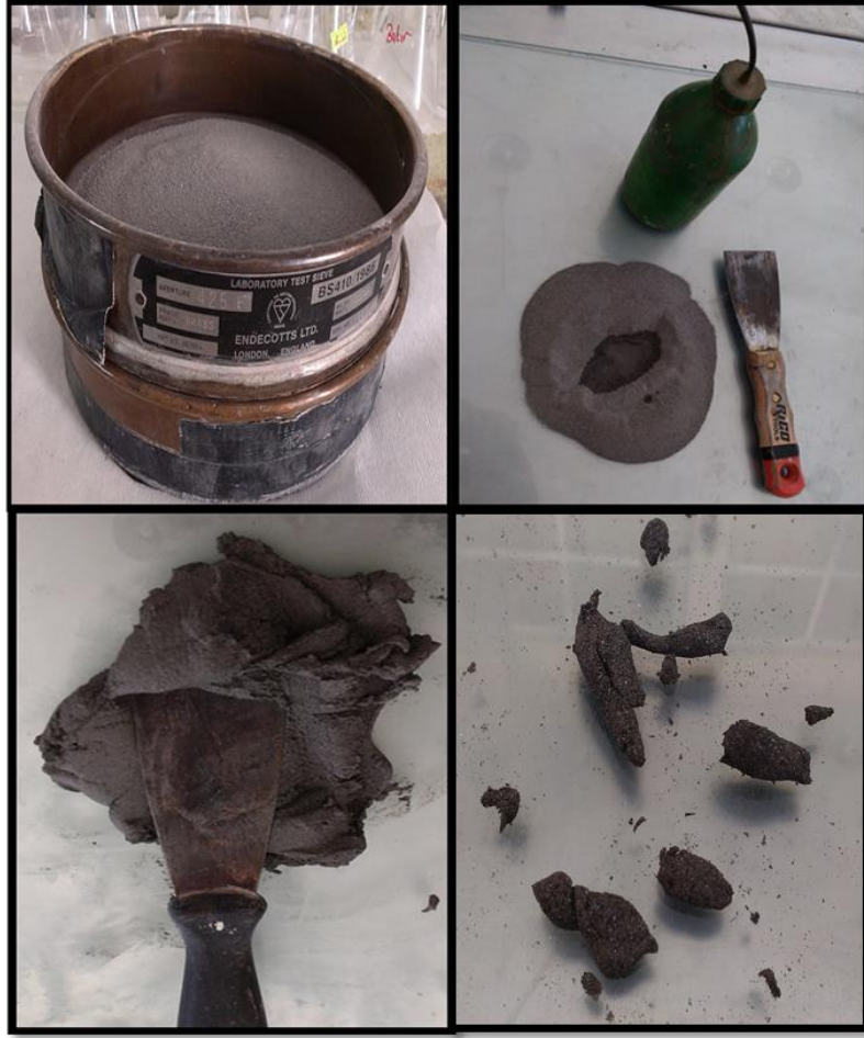
Şekil 3.19. Modifiye edilen uçucu kül numunelerinin, yuvarlanarak çapları yaklaşık 3 mm olan zemin çubukları haline getirilememesi
