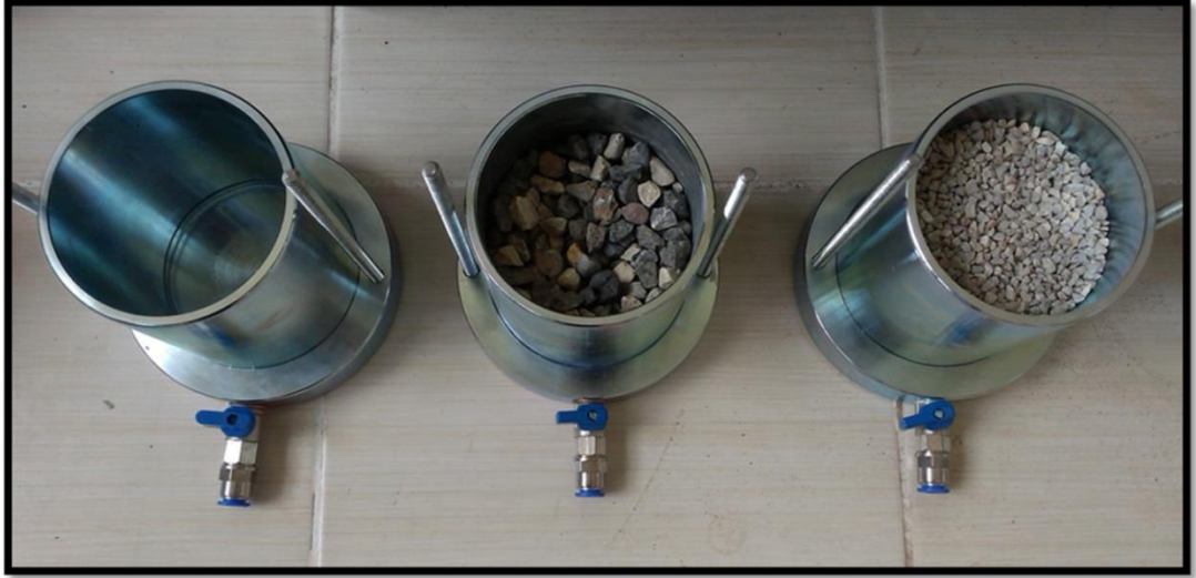
Şekil 3.10. Hidrolik iletkenlik kalıplarında çakıllar ve kırma taşlarla belirli bir yükseklik oluşturulması
