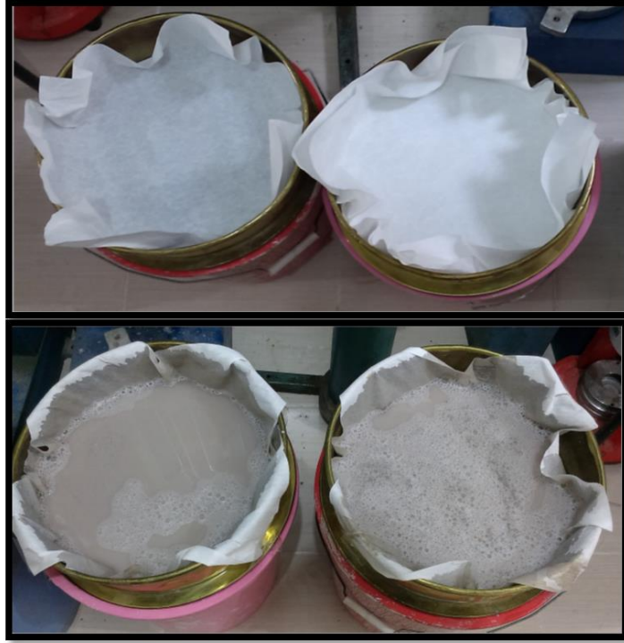
Şekil 3.7. Üretilen malzemenin filtre edilmesi
