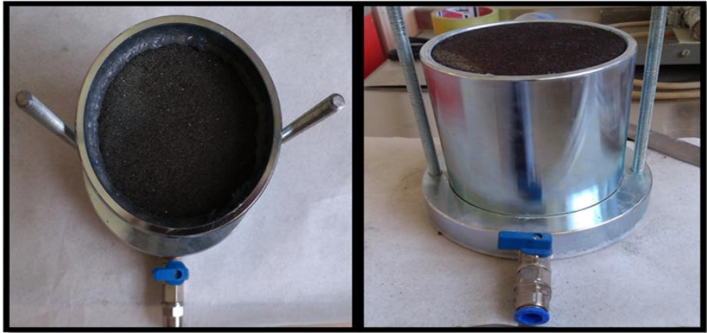
Şekil 3.14. Yerleştirilen malzemenin etrafına şeffaf silikon çekilmesi ve filtre kâğıdı, poroz taşı, tekrar filtre kâğıdı konularak kalıp kapağının kapatılması
