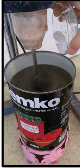
Şekil 3.5. Karışıma 24 gr NaOH eklenmesi
