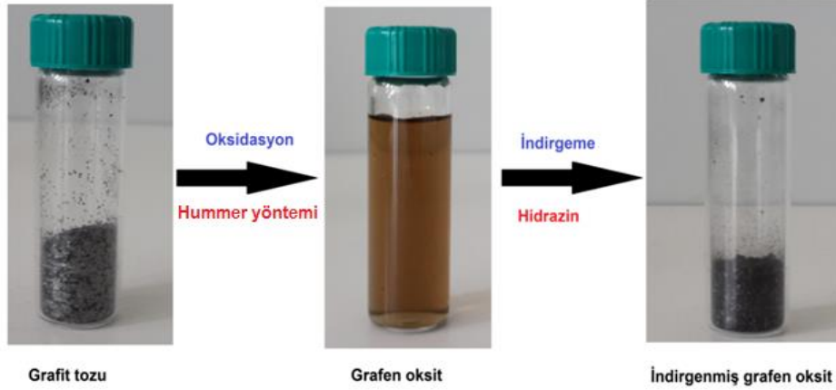
Şekil 2.1. Grafen oksit ve indirgenmiş grafen oksidin kimyasal yöntemle sentezi [139]
