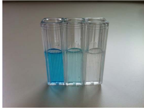
Fotoğraf 3.5. MB boyasının başlangıç, 1 saat ve 24 saat gideriminden sonraki görünümü.
