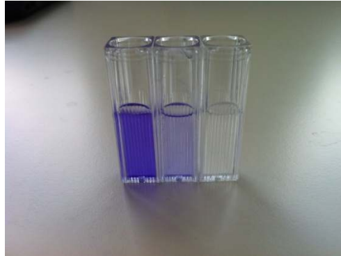
Fotoğraf 3.6. CV boyasının başlangıç, 1 saat ve 24 saat gideriminden sonraki görünümü.
