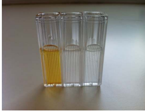
Fotoğraf 3.4. MR boyasının başlangıç, 1 saat ve 24 saat gideriminden sonraki görünümü.
