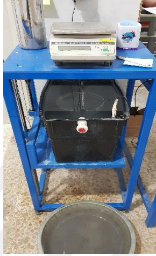
Şekil 1.21. Kaba agreganın özgül ağırlığını belirlemek için kullanılan aletler.
